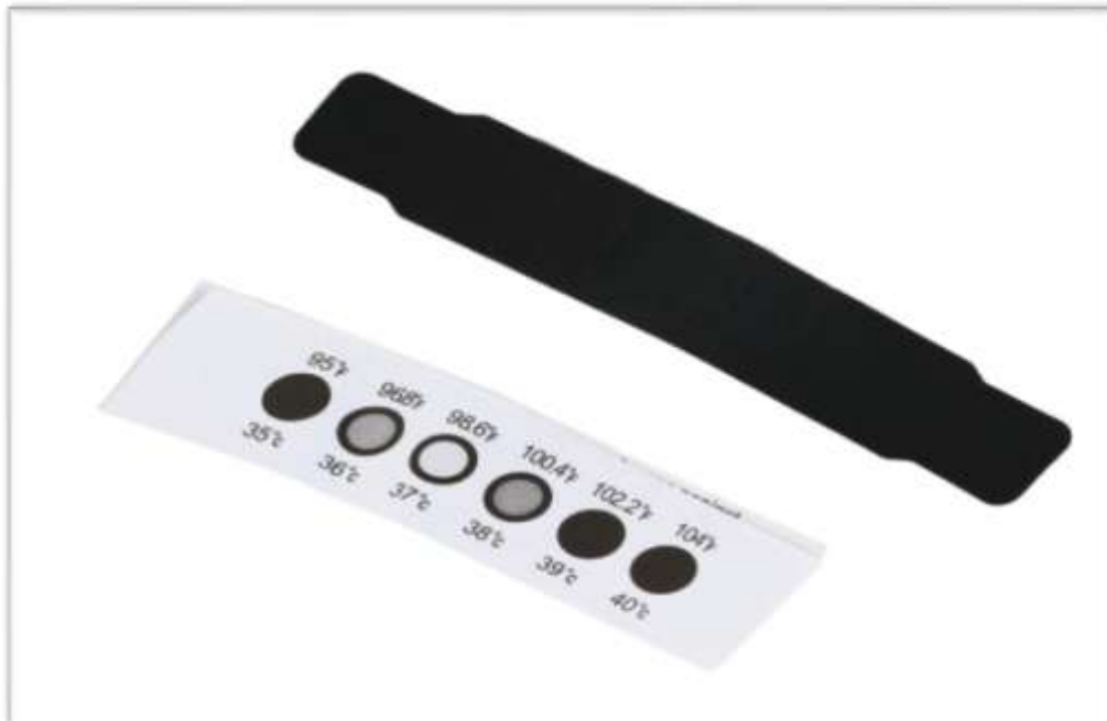
Slika 7: Traka za mjerenje temperature na čelu
