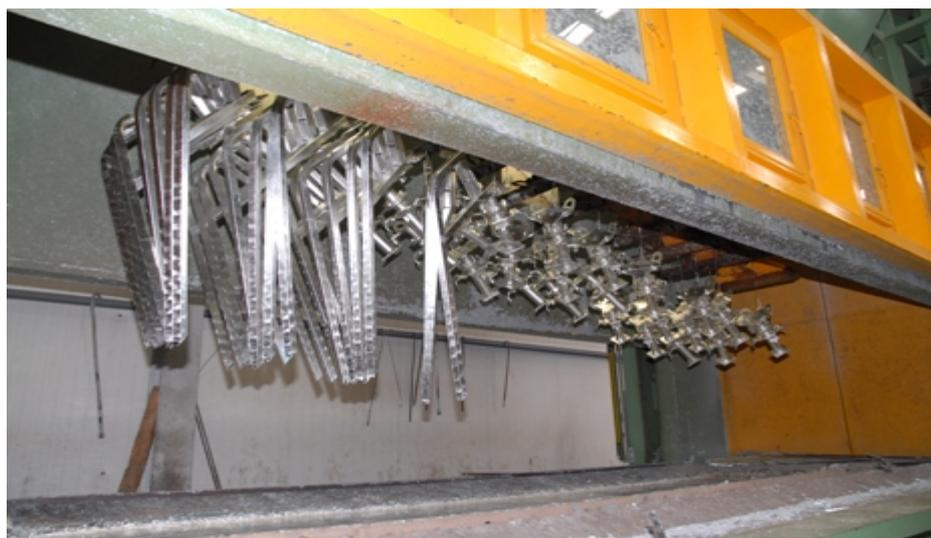
*Slika 1.1 Primjer vruće pocinčane komponente, „OMEGA“ [3]*
