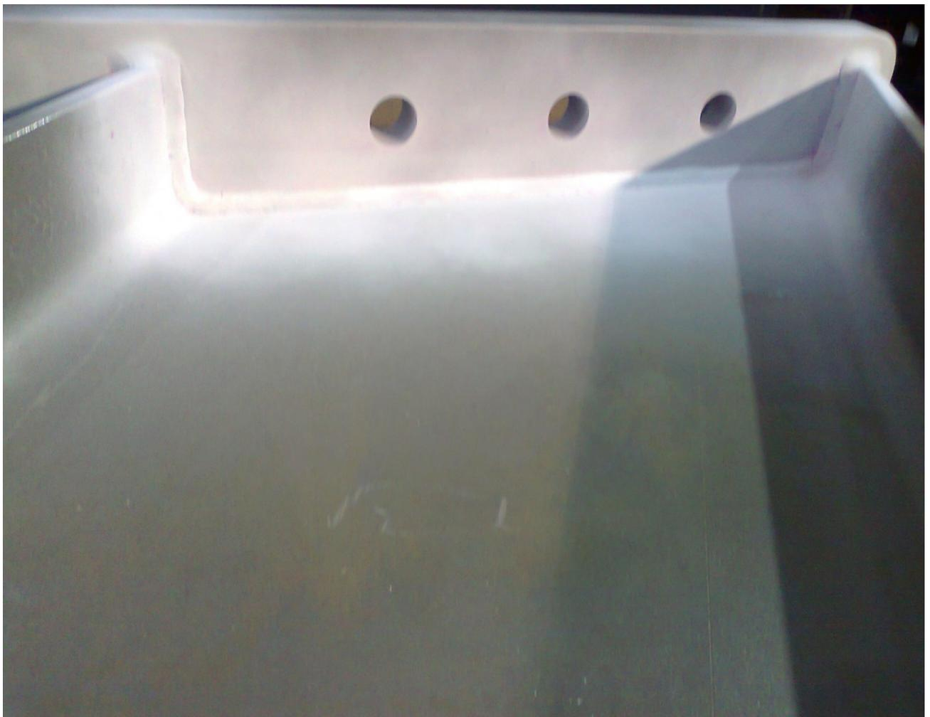
*Slika 9. 27 Završna slika penetrantske kontrole zavara*
