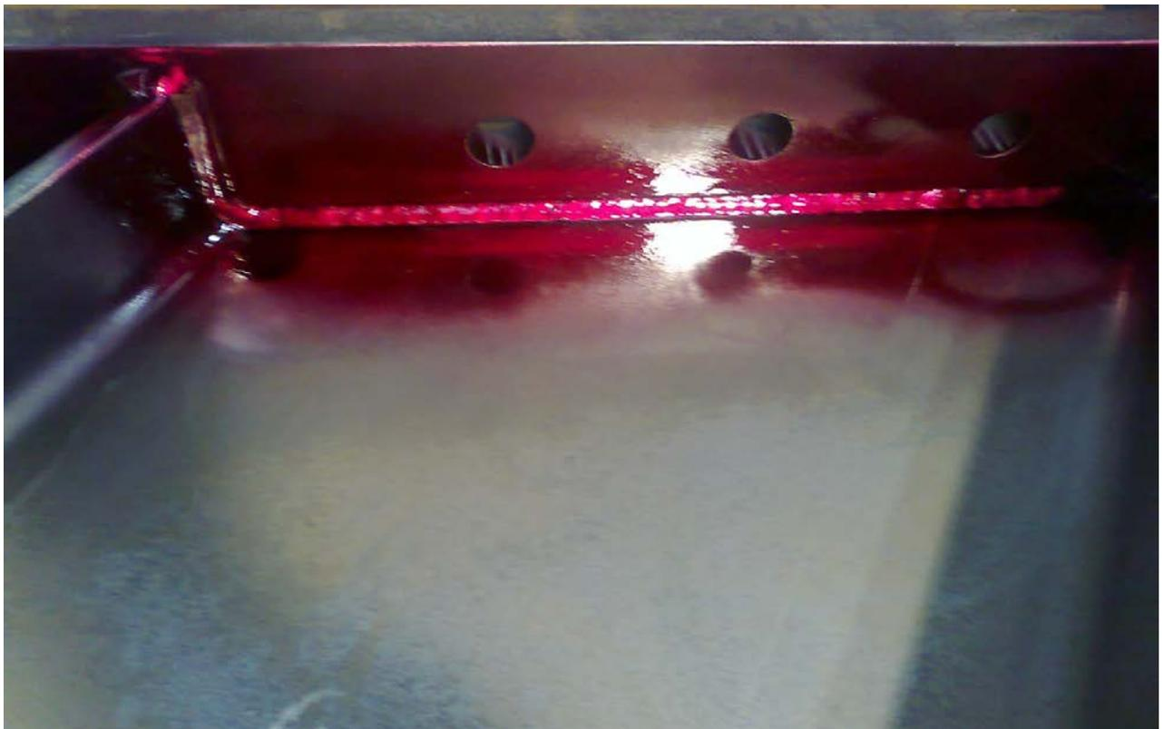
*Slika 9. 24 Nanošenje penetranta*
