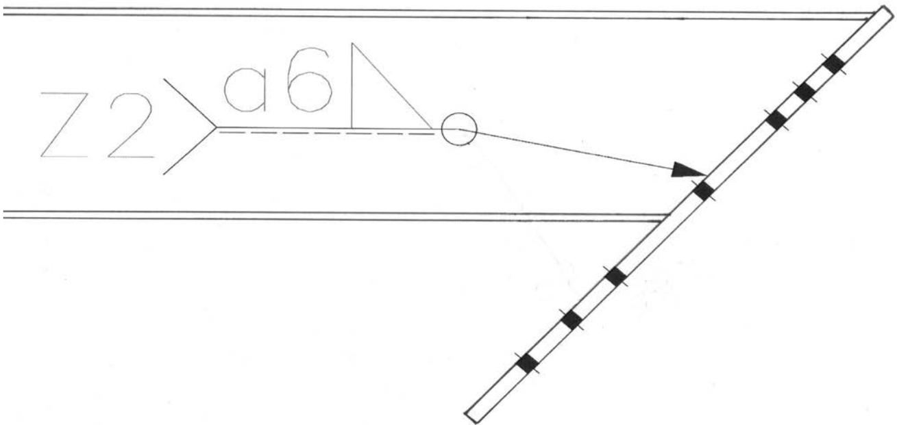
Slika 9. 21 Skica spoja IPE profila i spojne ploče
