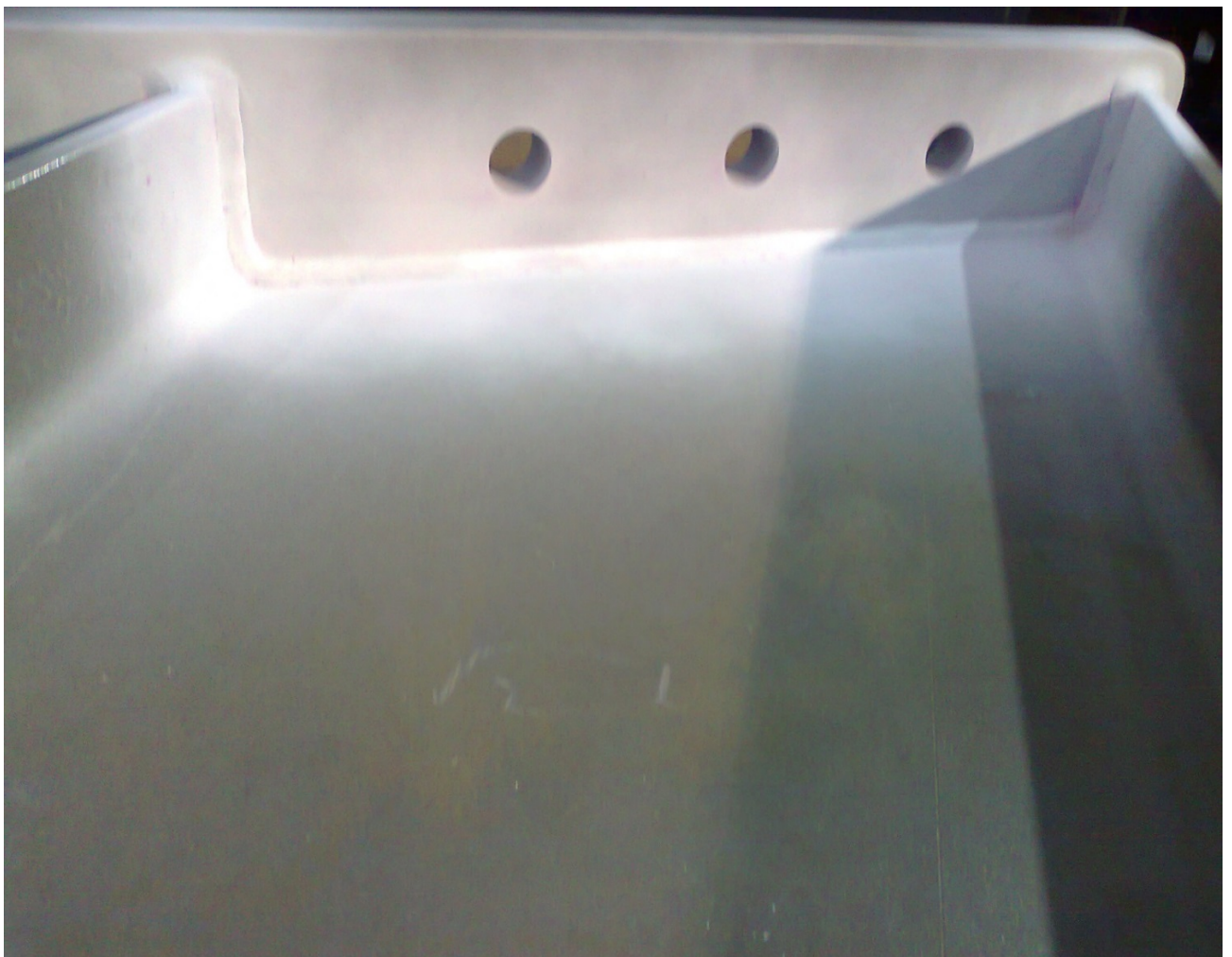
Slika 9. 27 Završna slika penetrantske kontrole zavara
