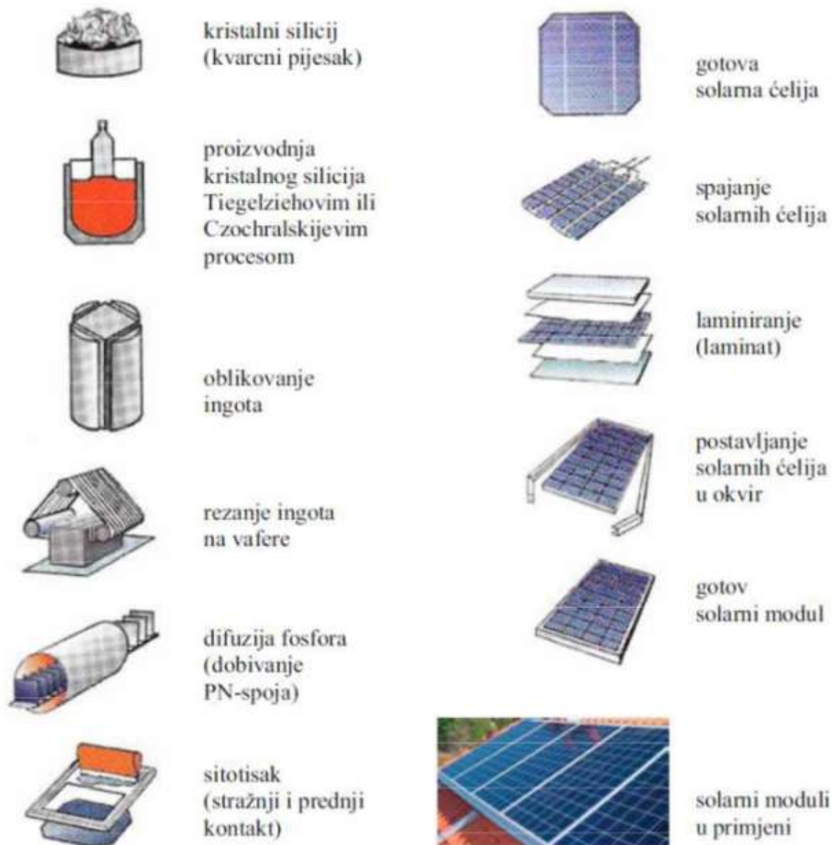
SLIKA 3.3. Postupak proizvodnje solarnih ćelija i FN modula [4]
