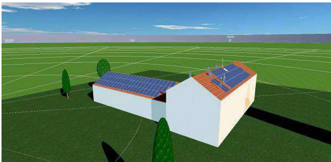
SLIKA 5.3. Prikaz 3D modela izrade objekta i SE u programu PV*Sol
