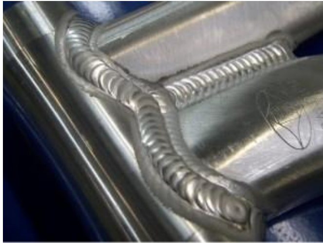
Slika 2.5 Zavareni spoj aluminija [9]
