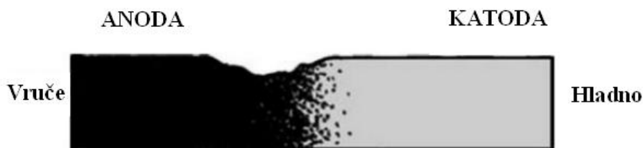
Slika 4.23 Primjer principa termogalvanske korozije [9]
