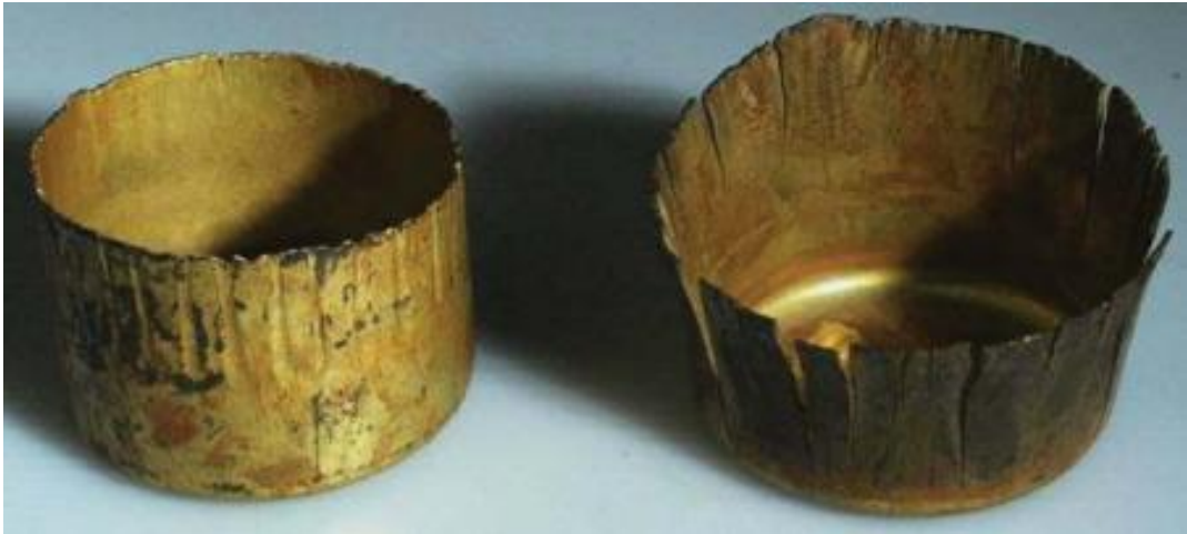
Slika 4.22 Primjer napetosne korozije čahure streljiva [34]
