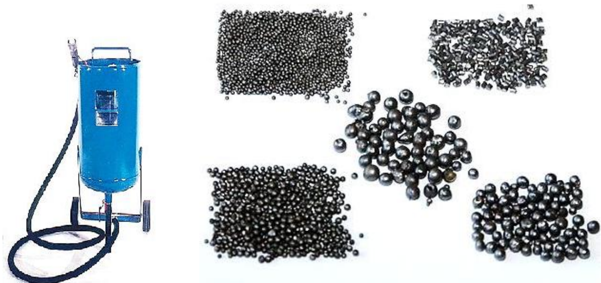
Slika 5.7 Uredaj za ručno sačmarenje (lijevo) i neke vrste sačme (desno) [43]
