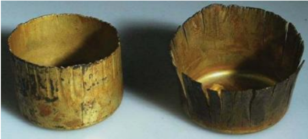
Slika 4.22 Primjer napetosne korozije čahure streljiva [34]
