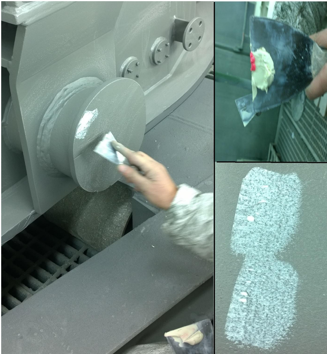
Slika 6.18 Popravljanje grešaka kitom
