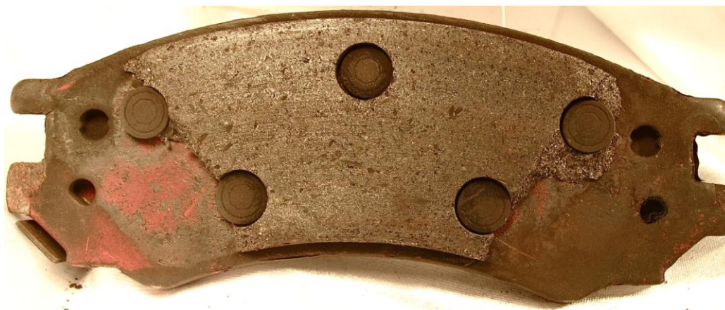
Slika 4.26 Primjer korozije uzrokovane trenjem kod automobilskih kočnica[36]
