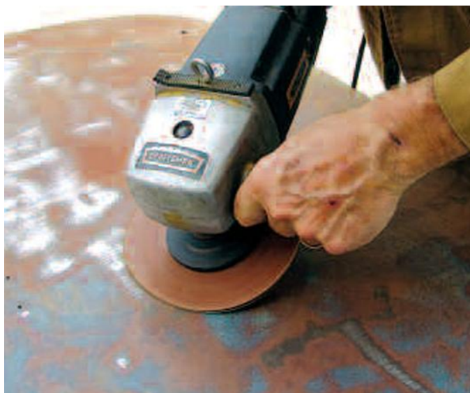
Slika lijevo prikazuje brušenje brusnim papirom, a slika desno žičanom četkom
