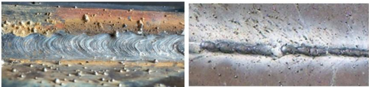
Slika 8.2 Izgled prskanja ili štrcanja kod zavarivanja [3]
