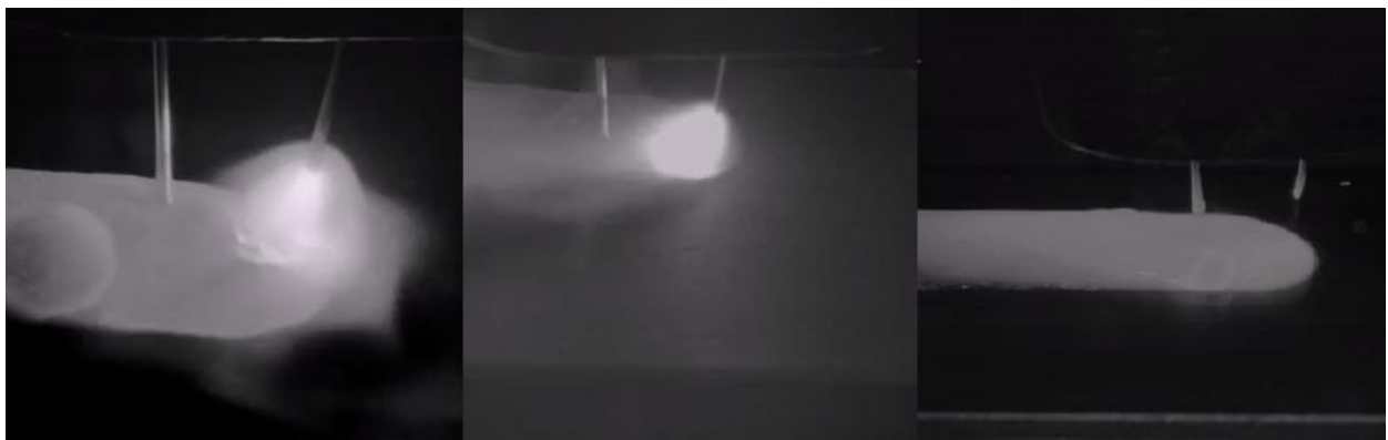
Slika 10.3 Realni prikaza prijenosa metala kod tandem zavarivanja [29]
