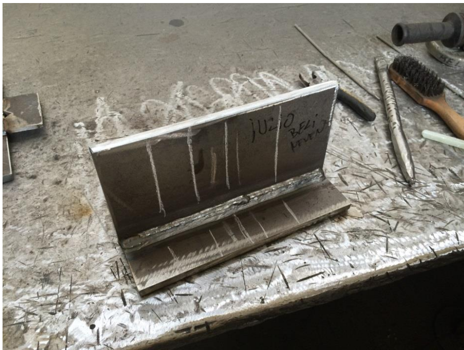
Slika 5.3. Kutni zavar (dužina 300 mm, debljina materijala 12 mm)
