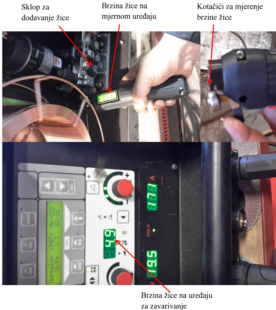
Slika 6.8. Mjerenje brzine žice
