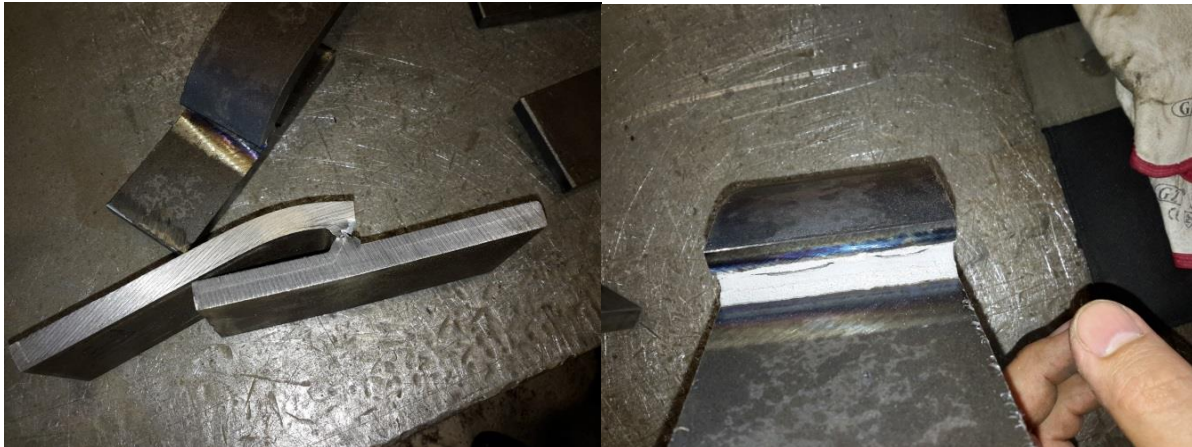
Slika 5.29. Prelomljeni ispitni uzorak
