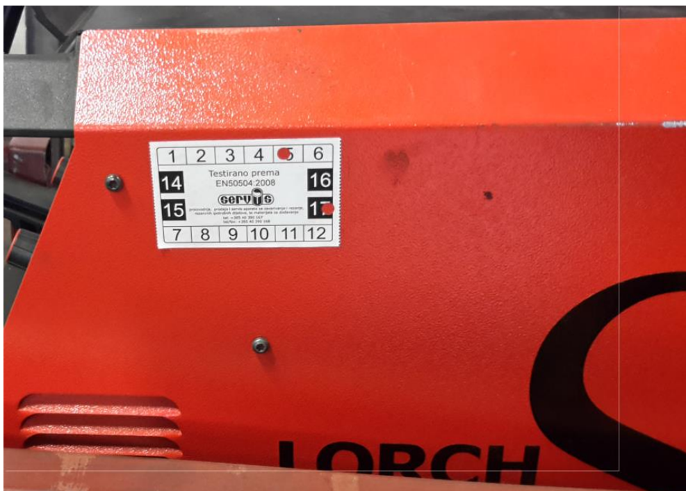
Slika 6.9. Naljepnica o ispravnosti uređaja
