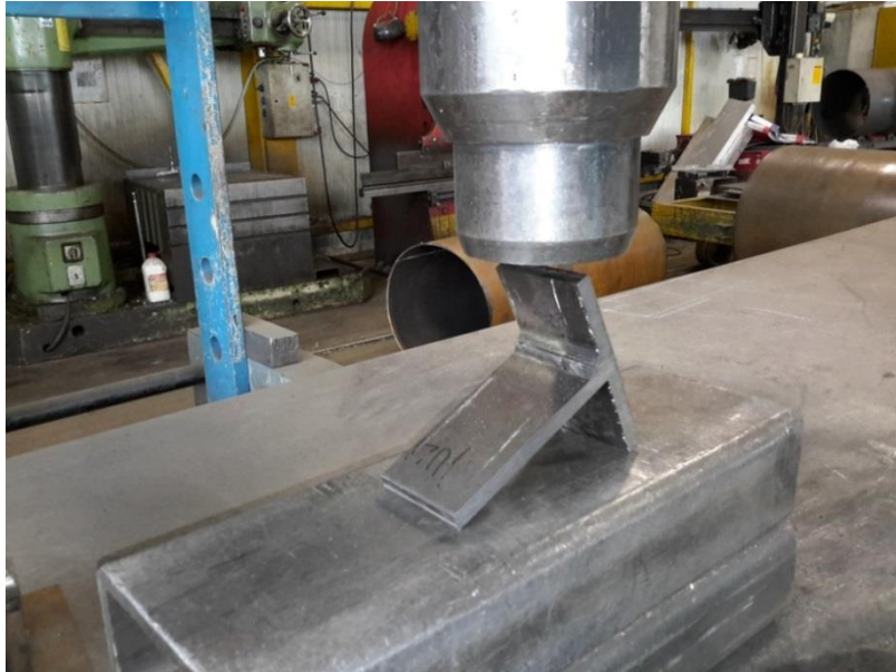
Slika 5.27. Ispitivanje loma – početak ispitivanja
