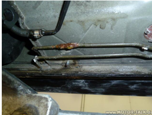
Slika 5.2.1 Korodirana kočiona cijev
