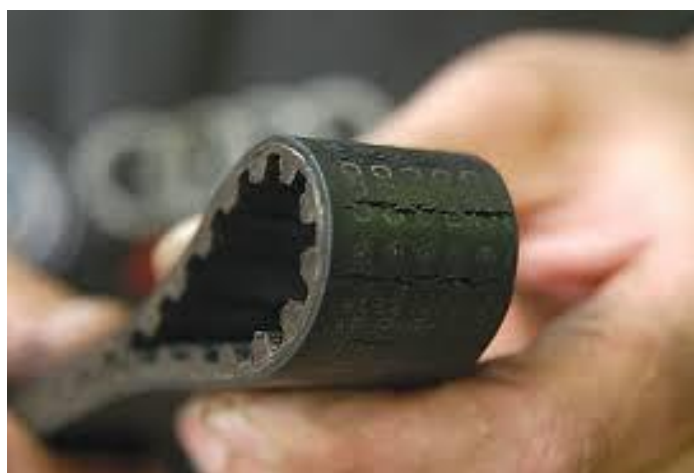
Slika 3.5.4 Dotrajali zupčasti remen
