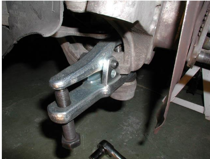
Slika 6.2.1 Zamjena kugle sa specijalnim alatom
