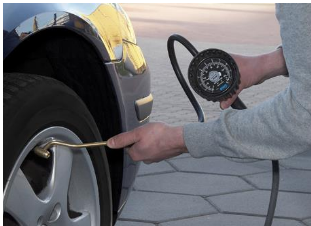
Slika 8.1.1 Provjera tlaka guma
