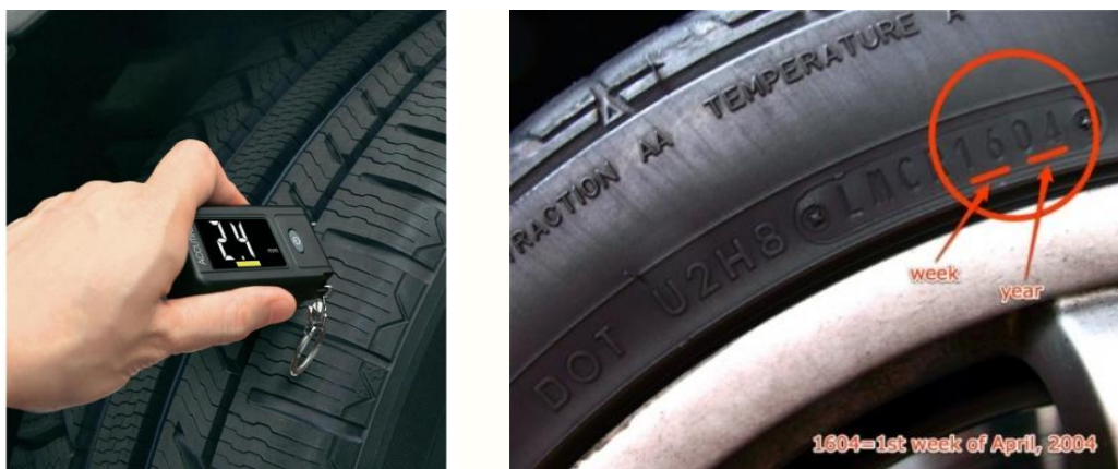
Slika 8.1.2 Provjera dubine šara i datum proizvodnje guma
