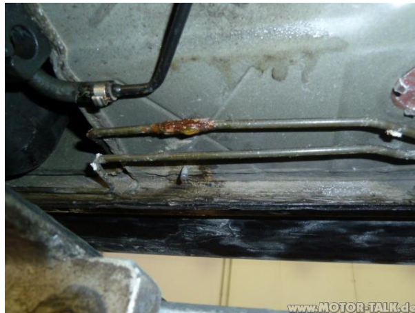
Slika 5.2.1 Korodirana kočiona cijev
