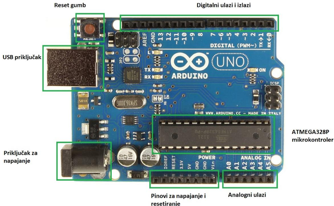
Slika 1 - Izgled Arduino R3 uređaja [3]
