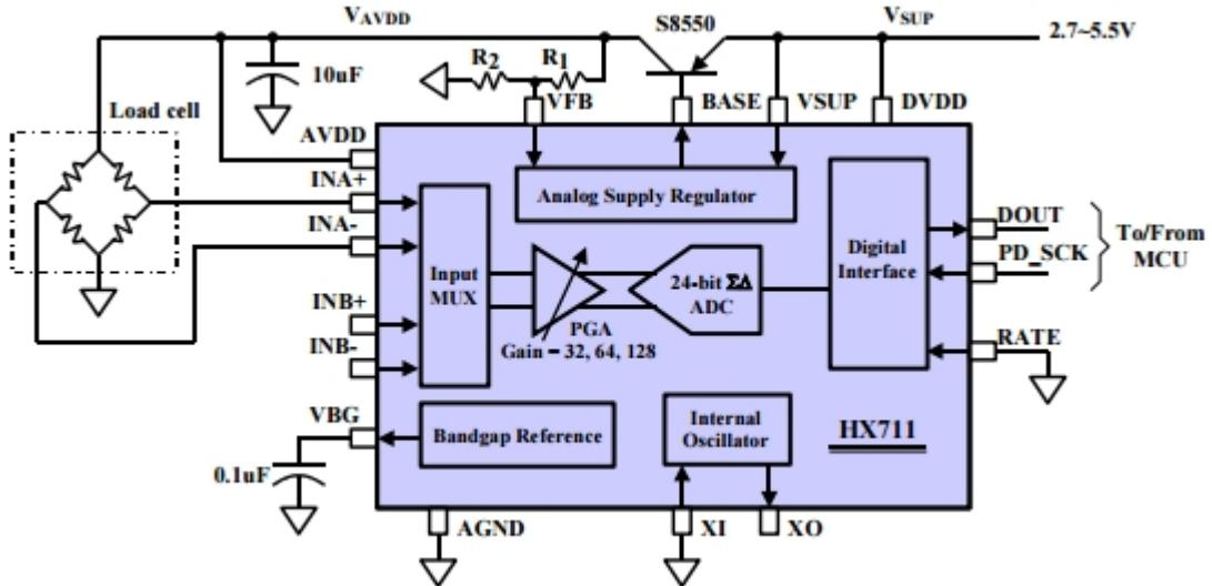
Slika 4 - Blok dijagram spajanja senzora na HX711 [2]
