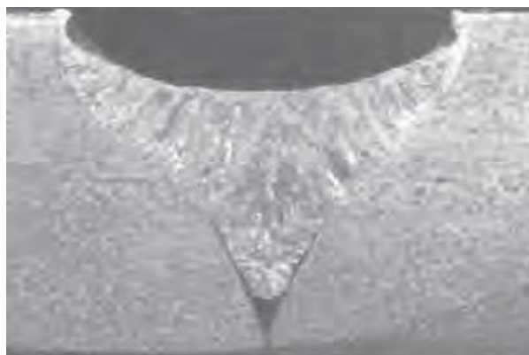
Slika 11. Primjer naljepljivanja u zavarenom spoju [1]
