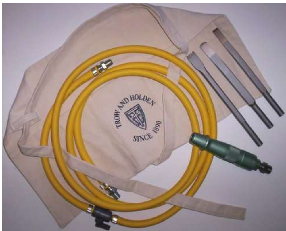
Slika 2.4. Pneumatski čekić sa setom dlijeta i crijevom za dotok zraka
