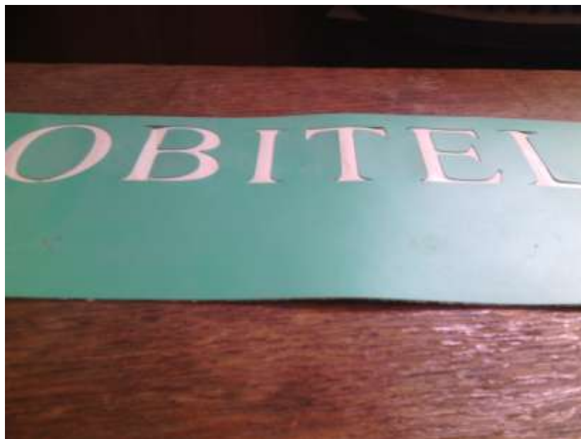
Slika 2.6. Folija za pjeskarenje sa izrezanom željenom gravurom
