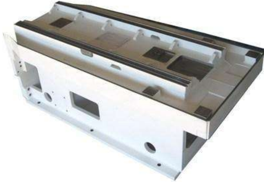
Slika 4.2. Zavarena izvedba postolja stroja
