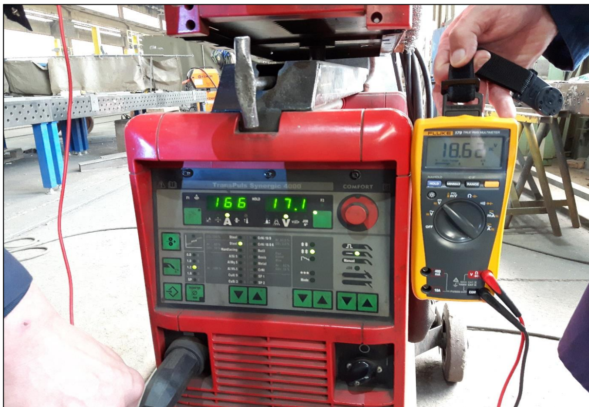
Slika 9.3 Mjerenje napona za vrijeme zavarivanja
