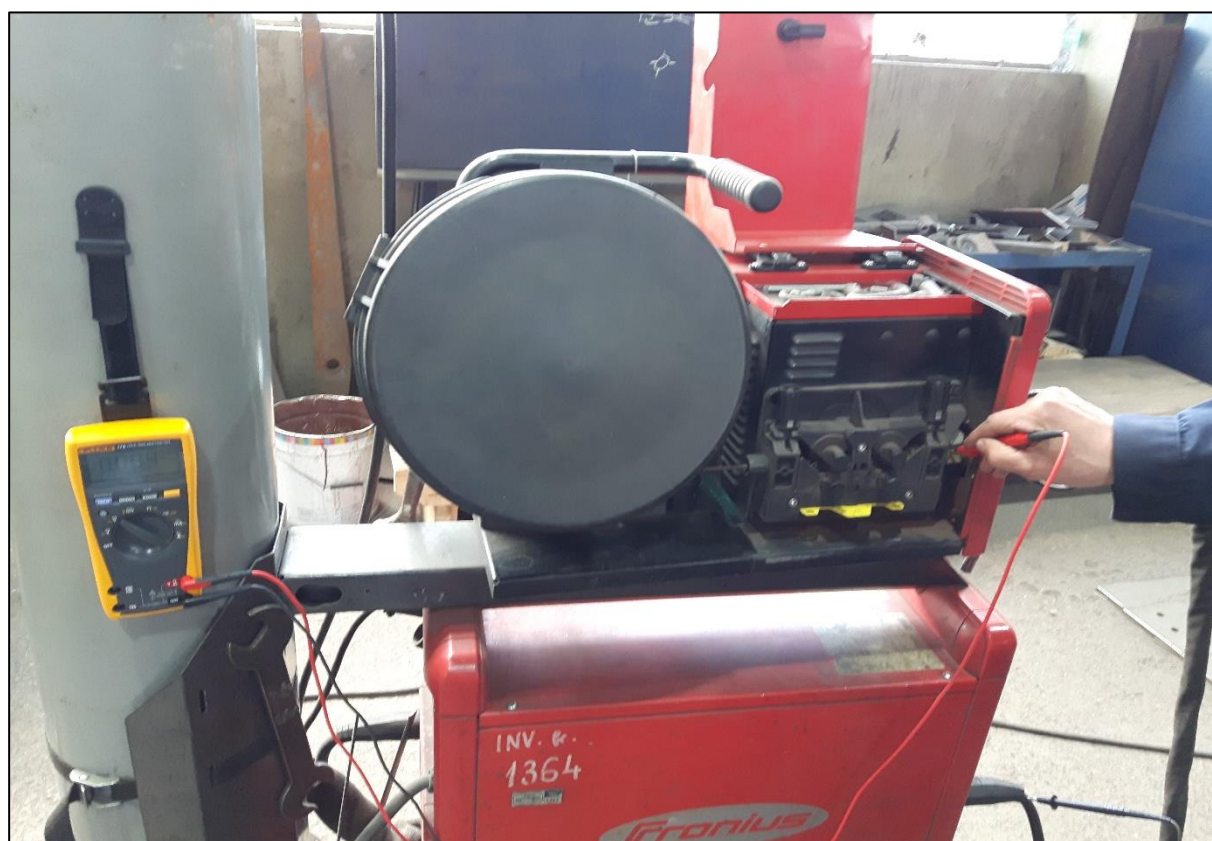
Slika 9.2 Spajanje voltmetra za mjerenje napona praznog hoda
