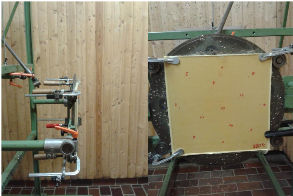
Slika 4.4. Stezanje i namještanje ploče
