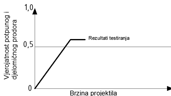
Slika 2.11. Utvrđivanje granice V50 [5]
