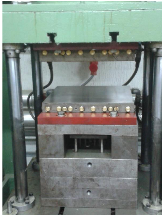
Slika 3.1. Preša sa kalupom
