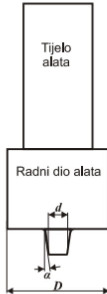
Slika 15 D - promjer čela alata, d - promjer trna alata, \alpha - kut nagiba trna alata [13]
