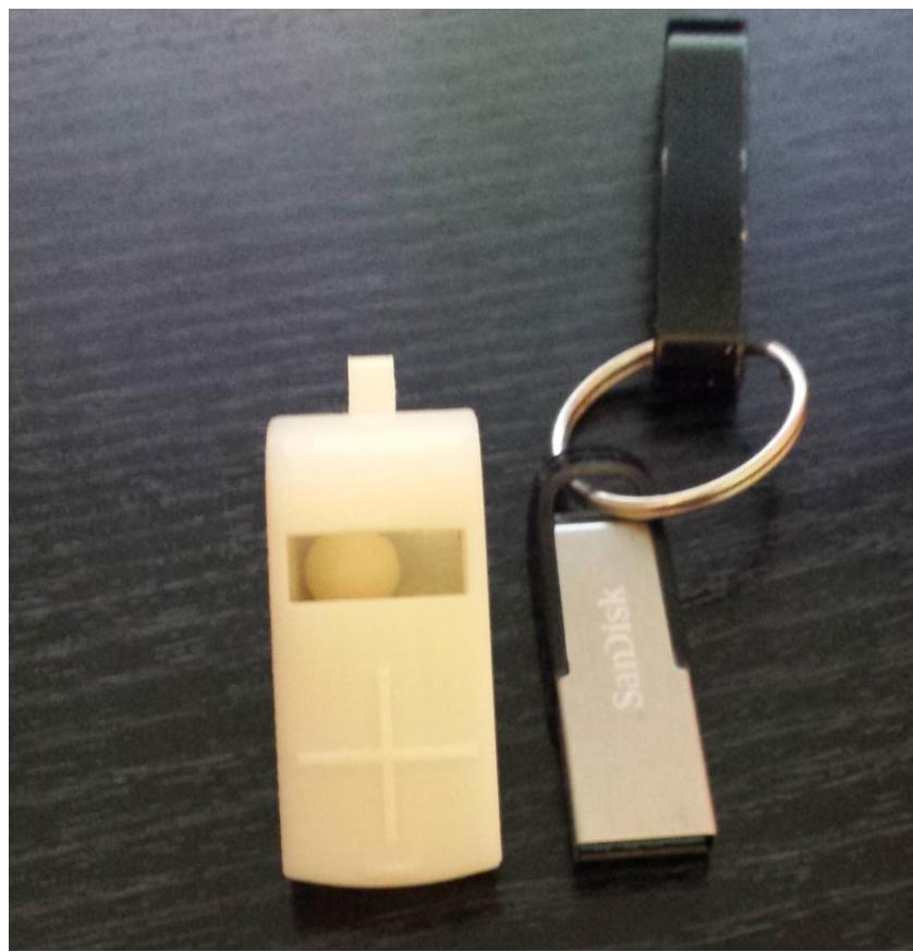
Slika 6.9 konačan proizvod dobiven Dimension Elite printerom
