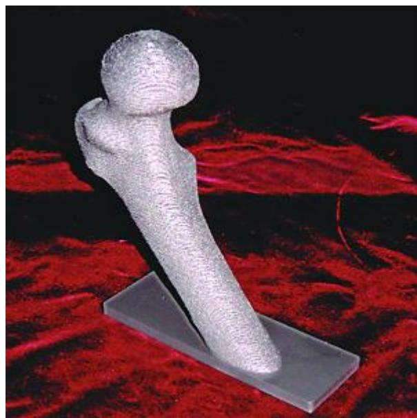
*Slika 3.10 Primjer zamjenskog kuka LENS postupkom [32]*
