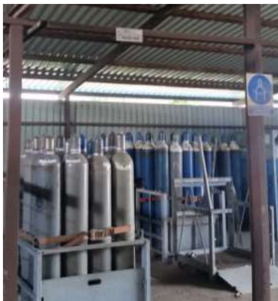
Slika 6.13 Skladištenje boca sa zaštitnim plinovima
