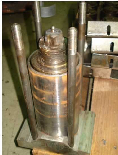
Slika 5.5: Opružni amortizer sa kućištem
