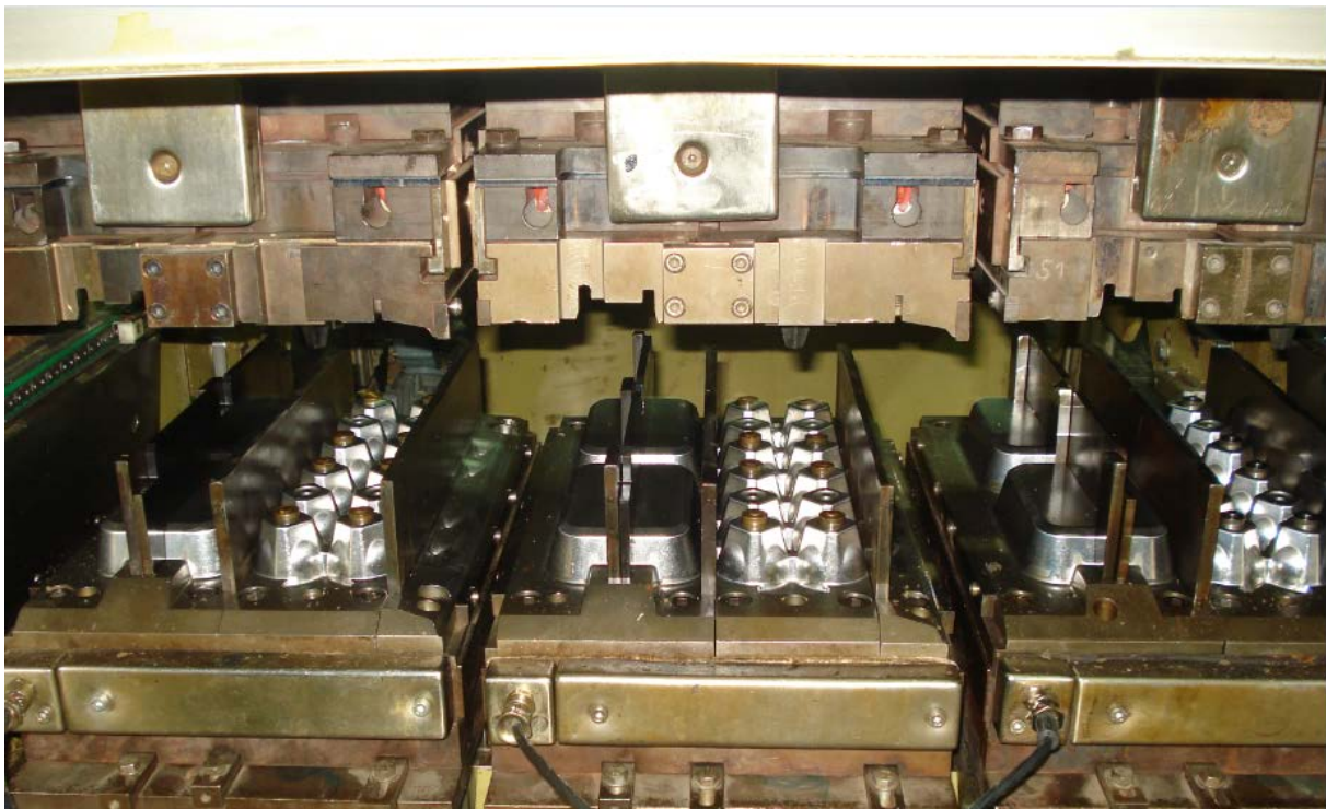
Slika 4.2: Gornji i donji alati sa podizačima
