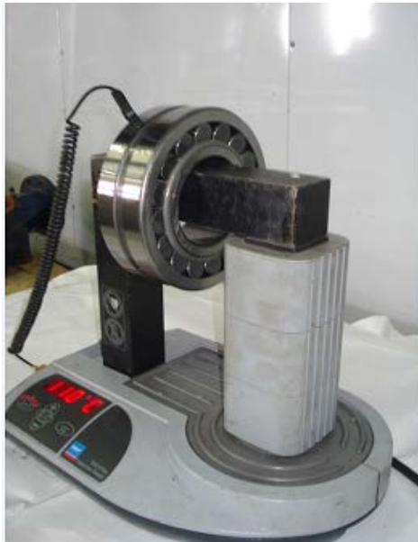
Slika 5.9: Indukcijski grijač ležaja
