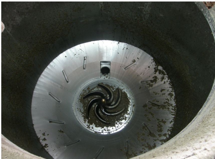
Slika 2.2: Unutrašnjost pulpera sa nožem
