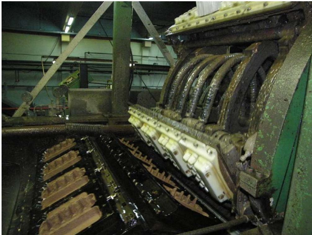
Slika 2.6: Uklapanje usisnog i presnog rotora
