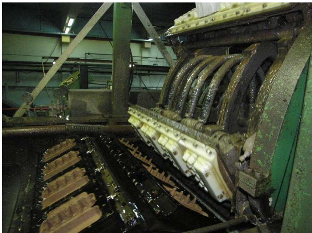
*Slika 2.6: Uklapanje usisnog i presnog rotora*
