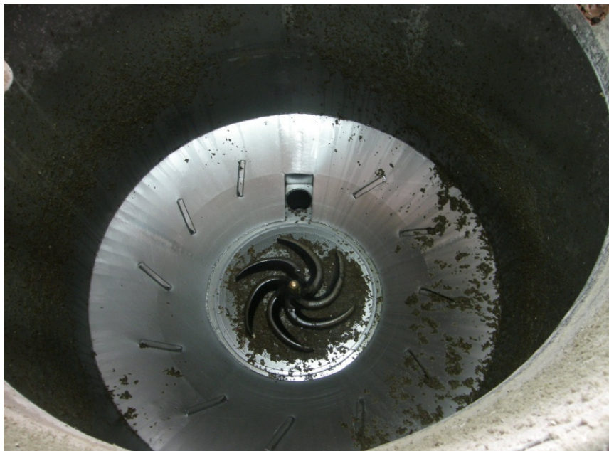
Slika 2.2: Unutrašnjost pulpera sa nožem
