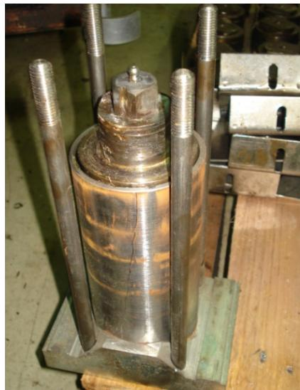
*Slika 5.5: Opružni amortizer sa kućištem*
