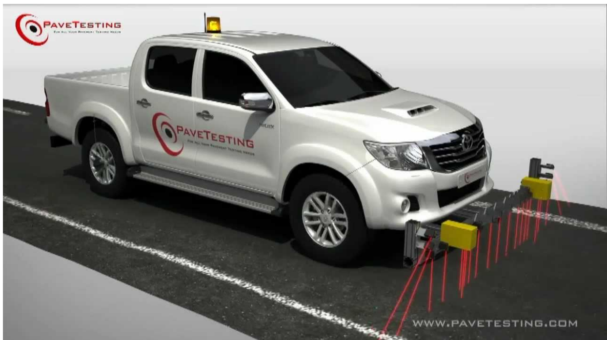
Slika Error! No text of specified style in document..16 Laserski profilometri montirani na tehničko vozilo [15]
