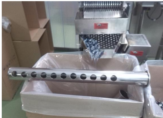
Slika 16: Način uzorkovanja kapsula prilikom pregleda sa stroja
