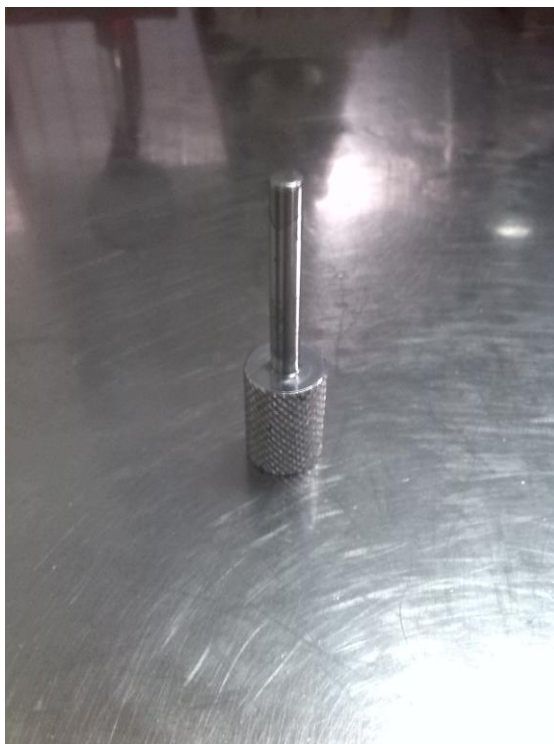
Slika 9: Uteg za mjerenje vanjskog promjera kapsula
