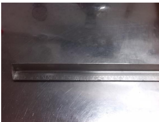
Slika 14: Ravnalo za mjerenje dužine predzatvorenih kapsula
