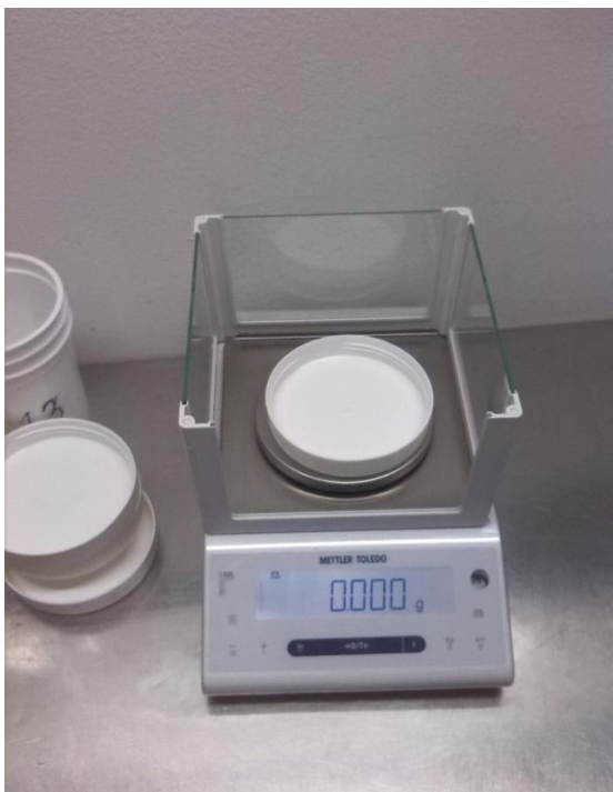
Slika 15: Digitalna vaga za mjerenje masa kapsula
