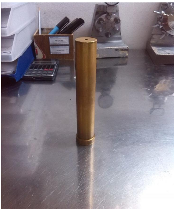
Slika 6: Uteg za ispitivanje krhkosti kapsula
