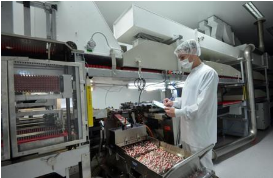
Slika 4: Stroj za proizvodnju kapsula
