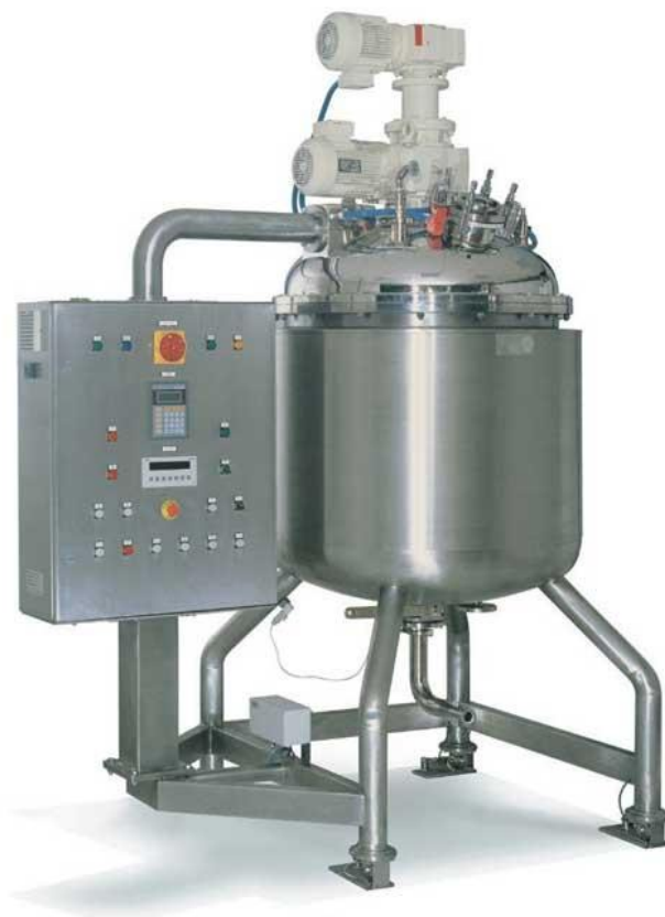
Slika 3: Melter za kuhanje želatine
