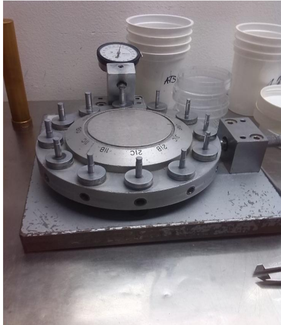
Slika 13: Pribor za mjerenje jačine ramena kapsula
