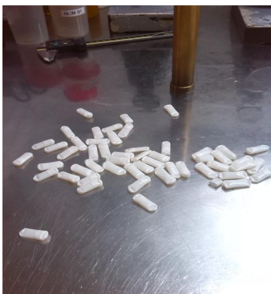
Slika 7: Testiranje krhkosti kapsula
