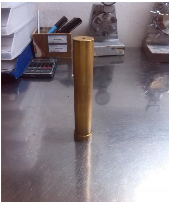
Slika 6: Uteg za ispitivanje krhkosti kapsula
