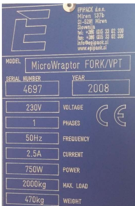
Slika 4.20 Tehničke karakteristike paletizatora MicroWaptor
