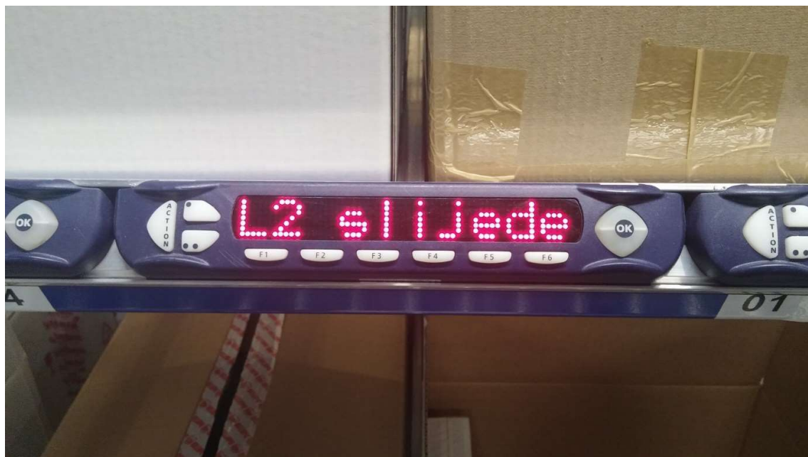
Slika 4.26 BayDisplay u PTL sustavu
