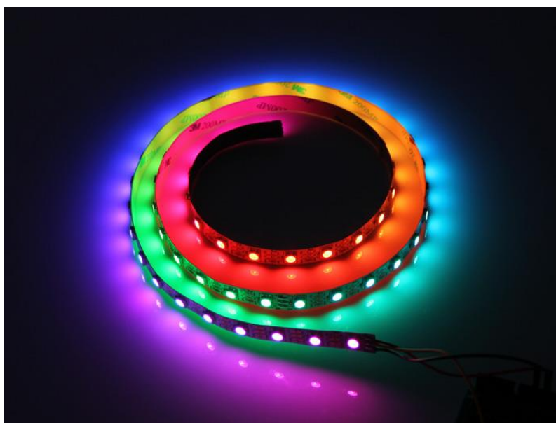
Slika 10. SMD Flex RGB LED traka [4]
