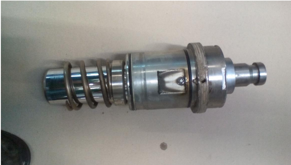
Slika 5.5 Klip sa čahurom nakon demontaže
