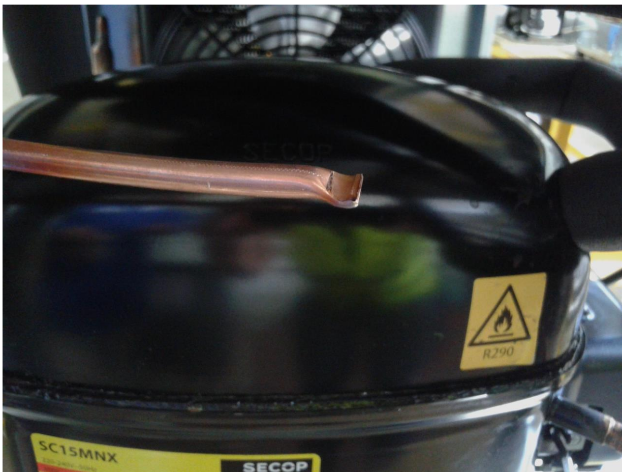
Slika 14. Bakrena cijev nakon zavarivanja
