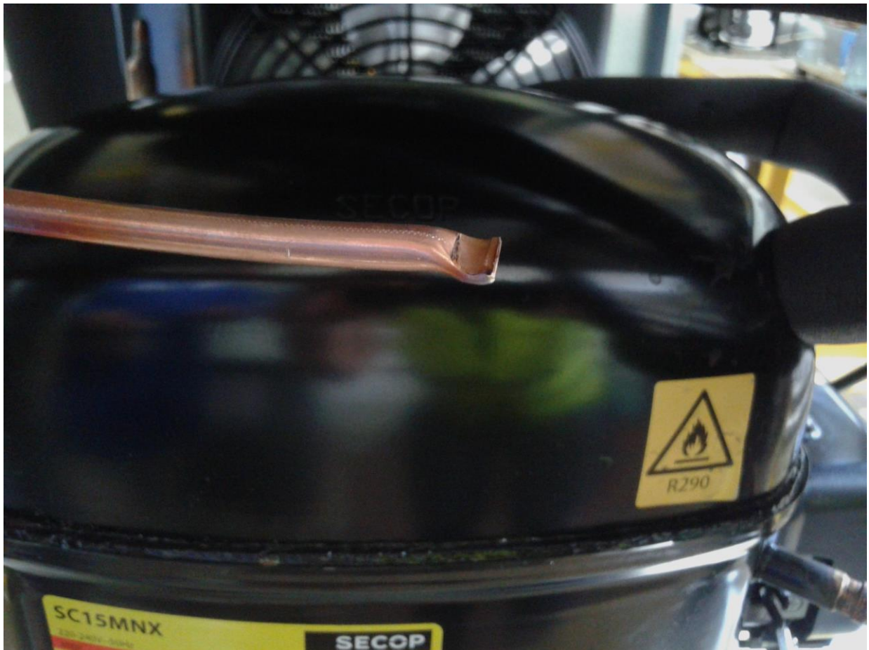
Slika 14. Bakrena cijev nakon zavarivanja
