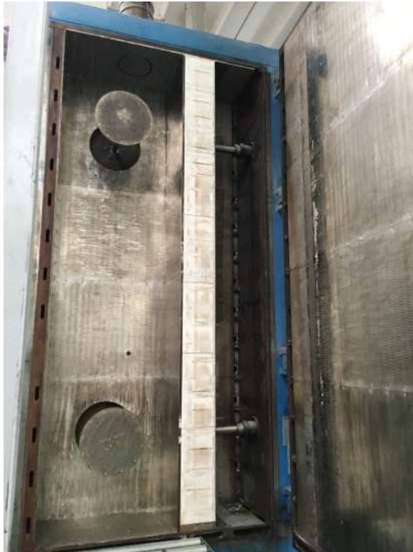
Slika 5.2 HIRSCH blockmold monolith
