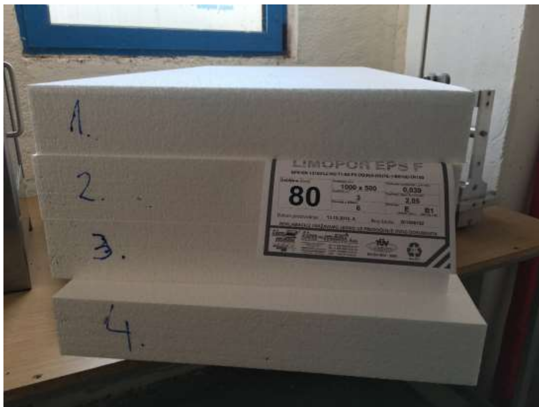
Slika 4.19 Uzorci za ispitivanje početnih dimenzija 1000x500 mm
