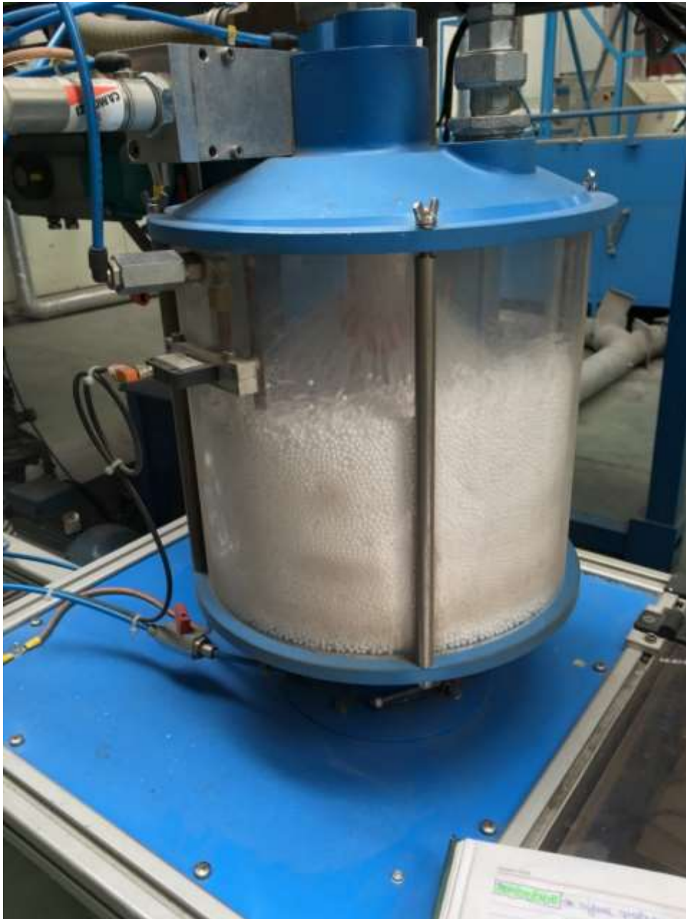
Slika 4.8 Vaga za vaganje stiropora
