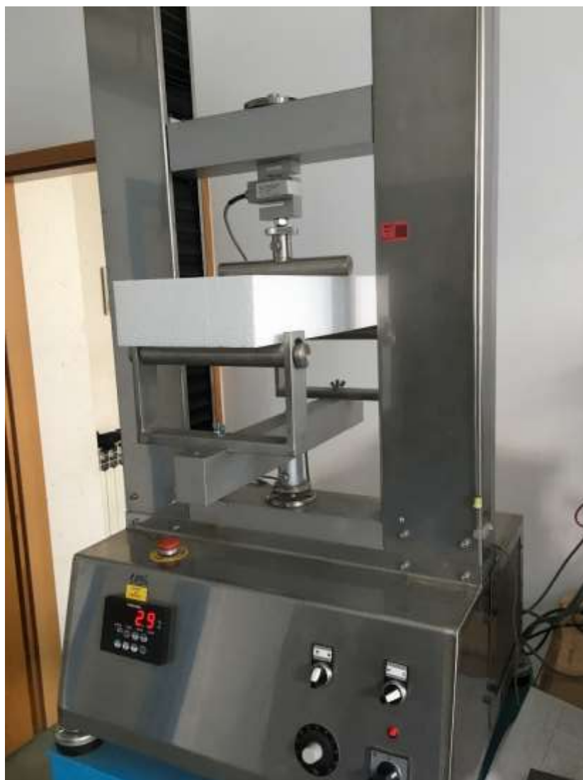
Slika 4.25 Ispitivanje čvrstoće na savijanje
