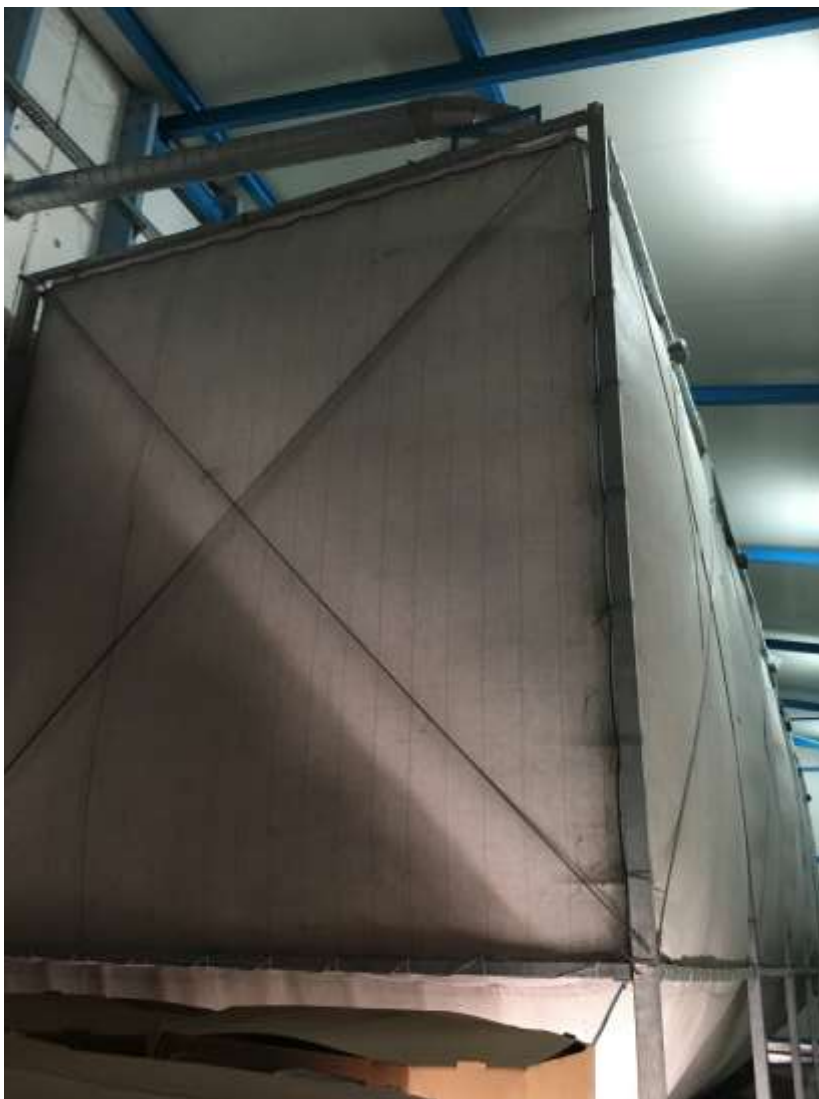
Slika 4.10 Silos za čuvanje ekspanziranih granula polistirena
