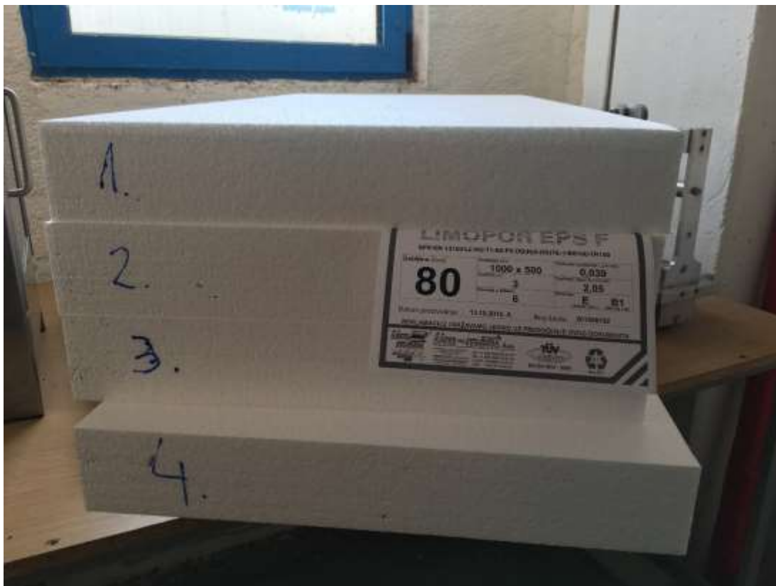
Slika 4.19 Uzorci za ispitivanje početnih dimenzija 1000x500 mm
