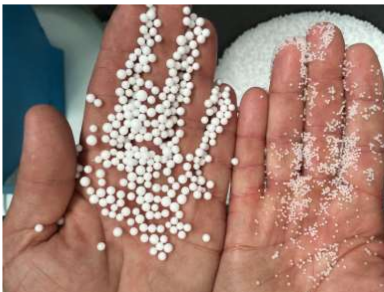
Slika 4.7 Granule PS nakon ekspandiranja (lijevo) i granule PS prije ekspandiranja (desno)
