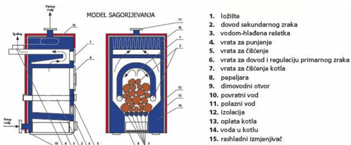
Slika 2.2 Opis dijelova kotla na kruta goriva
