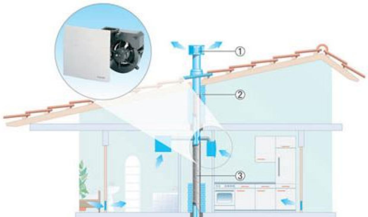
Slika 2.22 Princip prisilne lokalne ventilacije
