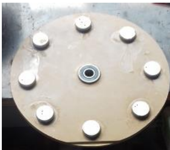
Slika 25: Disk sa pričvršćenim magnetima
