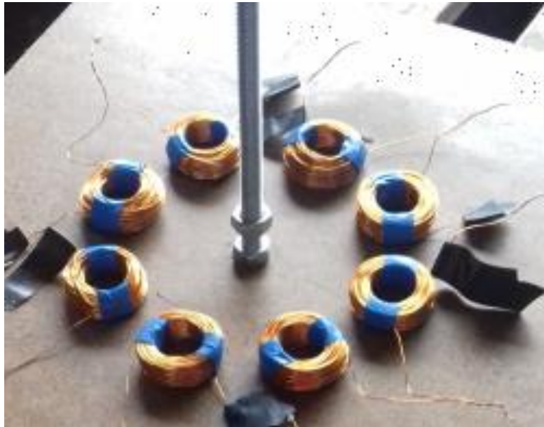
Slika 31: Položaj i način spajanja namotaja
