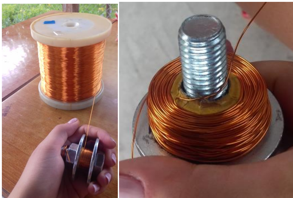
Slika 27: Postupak izrade namotaja
