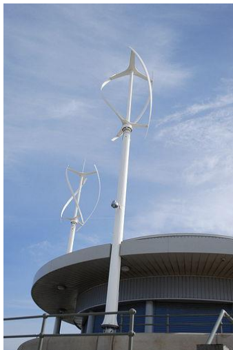
Slika 11. Vertikalna Darrieusova vjetroturbina sa spiralnim lopaticama [20]
