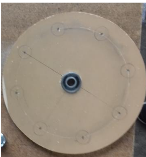
Slika 23: Disk s označenim položajem magneta
