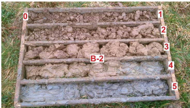
Slika 8.18 Jezgra sondažne bušotine B2
