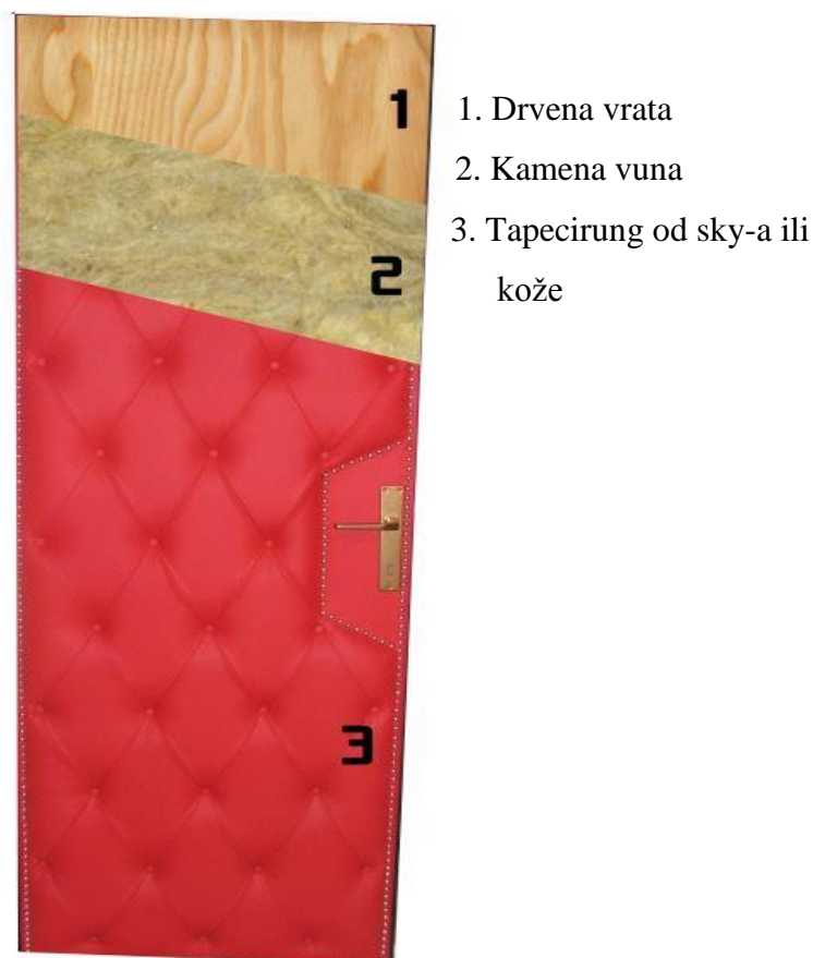
Slika 6.3.1. Prikaz slojeva zvučno izoliranih vrata
