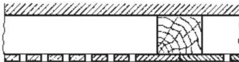
Slika 5.3.2. Presjek panelnog akustičnog rezonatora
