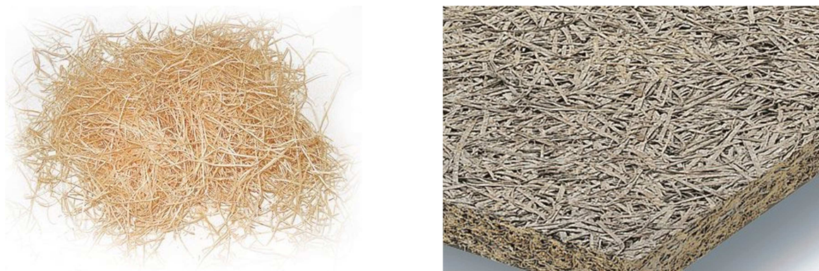
Slika 2.12 Drvena vuna u rastresitom stanju i u pločama
