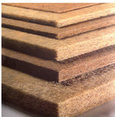
Slika 2.11 Ploče od kokosovih vlakana
