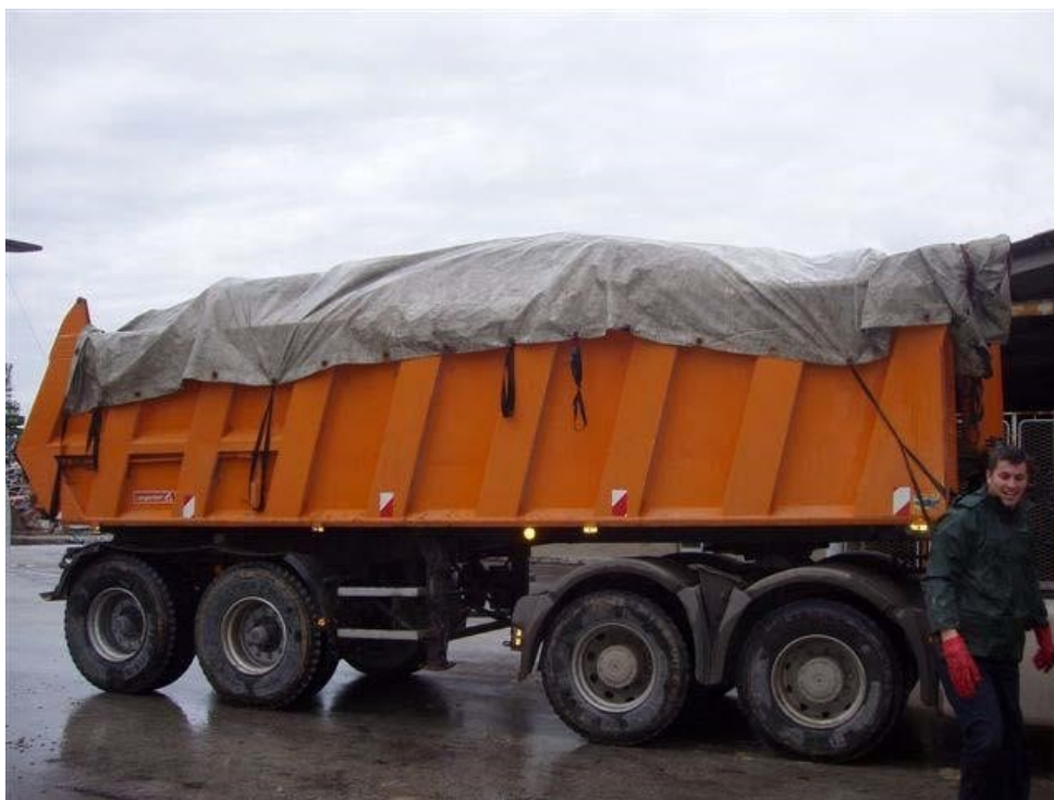
Slika 3.3. Prijevoz azbestnog otpada na odlagalište u posebnom vozilu(Izvor:www.otrovno.com, preuzeto 05.09.2016.)
