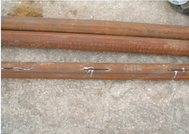
Slika 5.22. Perforiranje čelične cijevi 1,0 m od vrha cijevi
