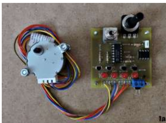
Slika 16. Izrađeni sklop za upravljanje brzinom vrtnje unipolarnog koračnog motora
