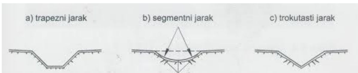
Slika 3.2: Poprečni presjeci jaraka (Dragčević, Rukavina 2006.)
