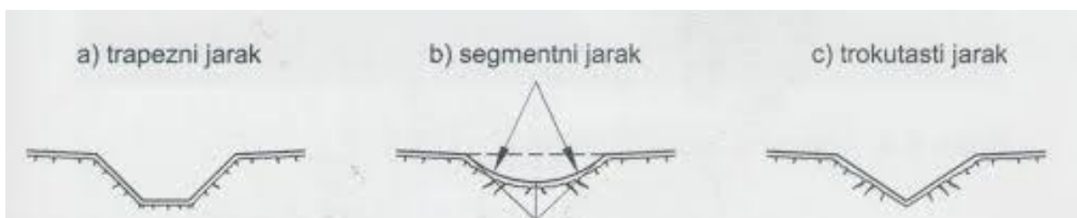
Slika 3.2: Poprečni presjeci jaraka (Dragčević, Rukavina 2006.)
