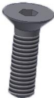
Slika 5.35 Vijak s upuštenom glavom M3x10
