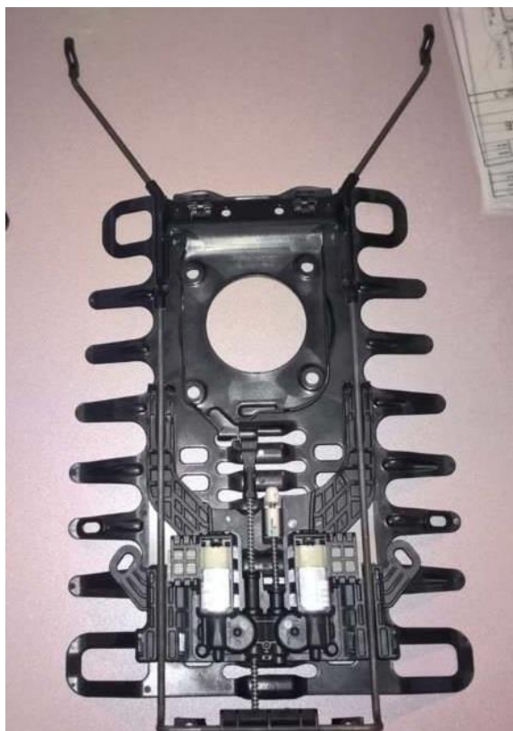
Slika 3.6 Zadnja strana nove serije Lumbar Support system-a
