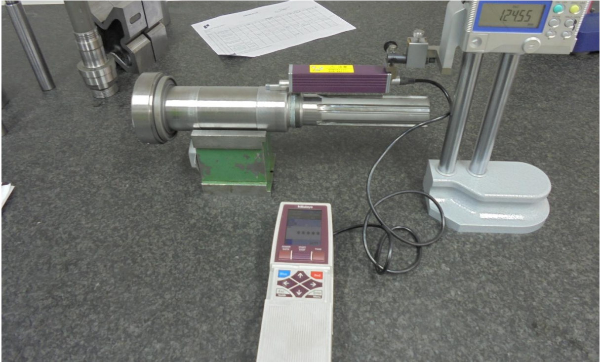
Slika 7.3.1. Prikaz mjerenja površinske hrapavosti vretena
