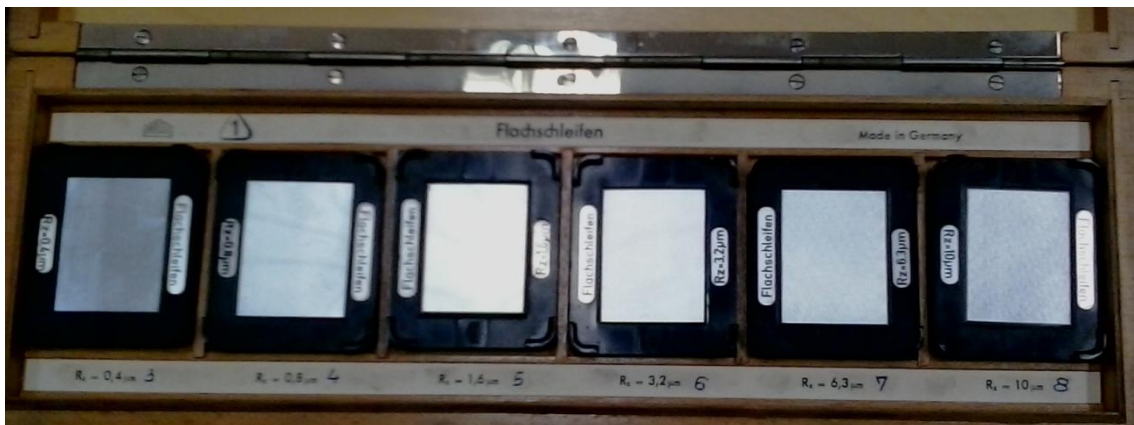
Slika 6.2.2 Set etalona za kalibraciju kod brušenja
