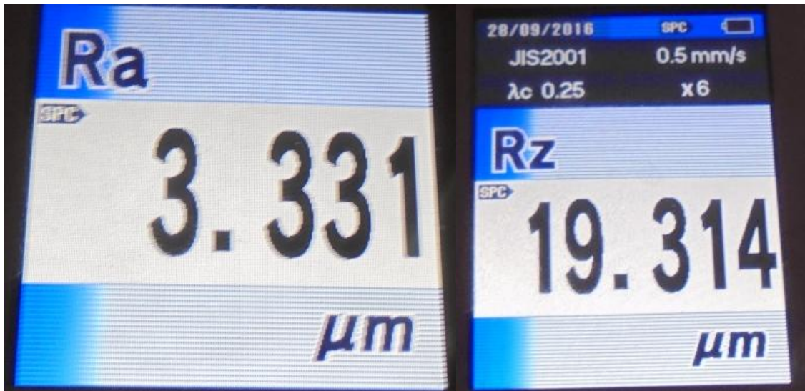
Slika 7.1.2 Izmjereni parametri tokarenja
