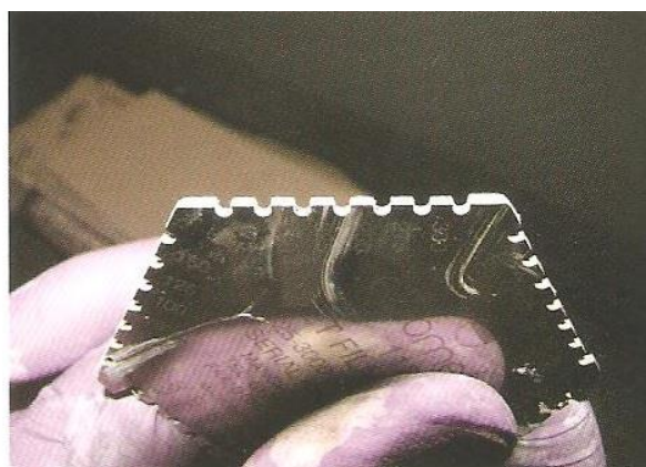
Slika 22 - Mjerenje debljine mokroga filma premaza (DMF) "češljem"
