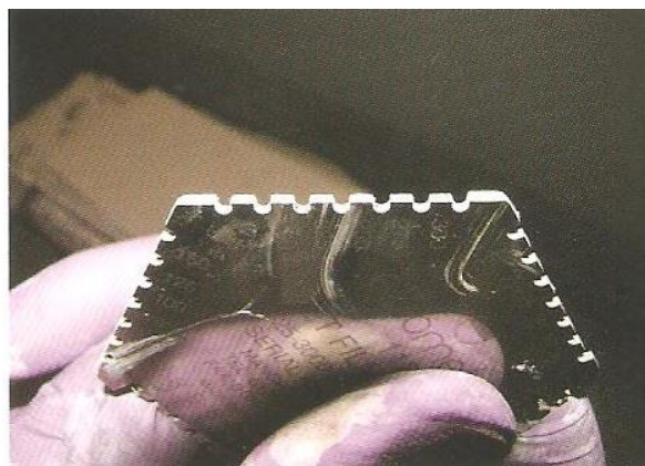
Slika 22 - Mjerenje debljine mokroga filma premaza (DMF) "češljem"
