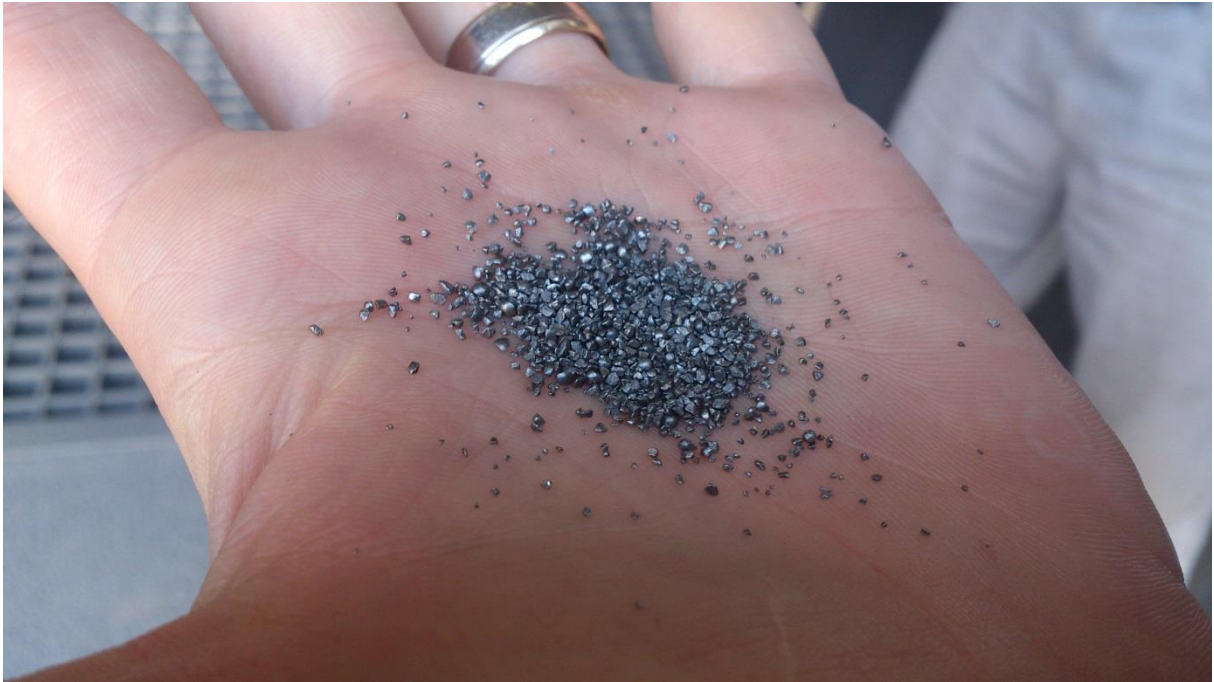
Slika 38 - Zrnca za "pranje" pijeskom (sweep blasting)
