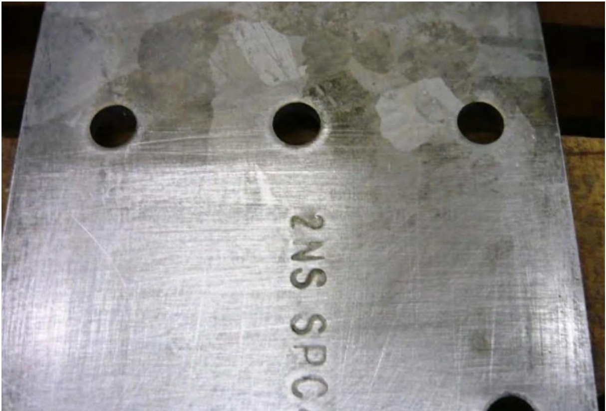
Slika 26 - Nepripremljena i pripremljena površina
