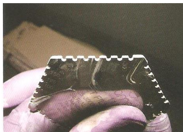
Slika 22 - Mjerenje debljine mokroga filma premaza (DMF) "češljem"
