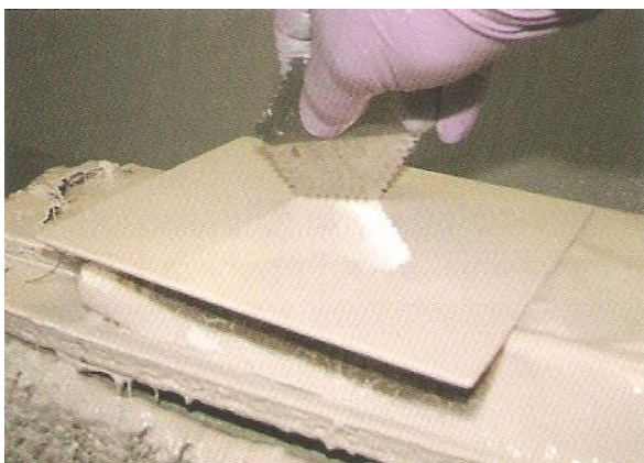
Slika 22 - Mjerenje debljine mokroga filma premaza (DMF) "češljem"
