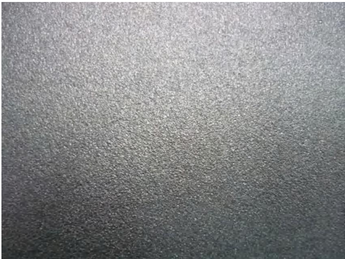
Slika 32 - Sačmareni čelik do stupnja Sa 2½ prema HRN EN ISO 8501-1
