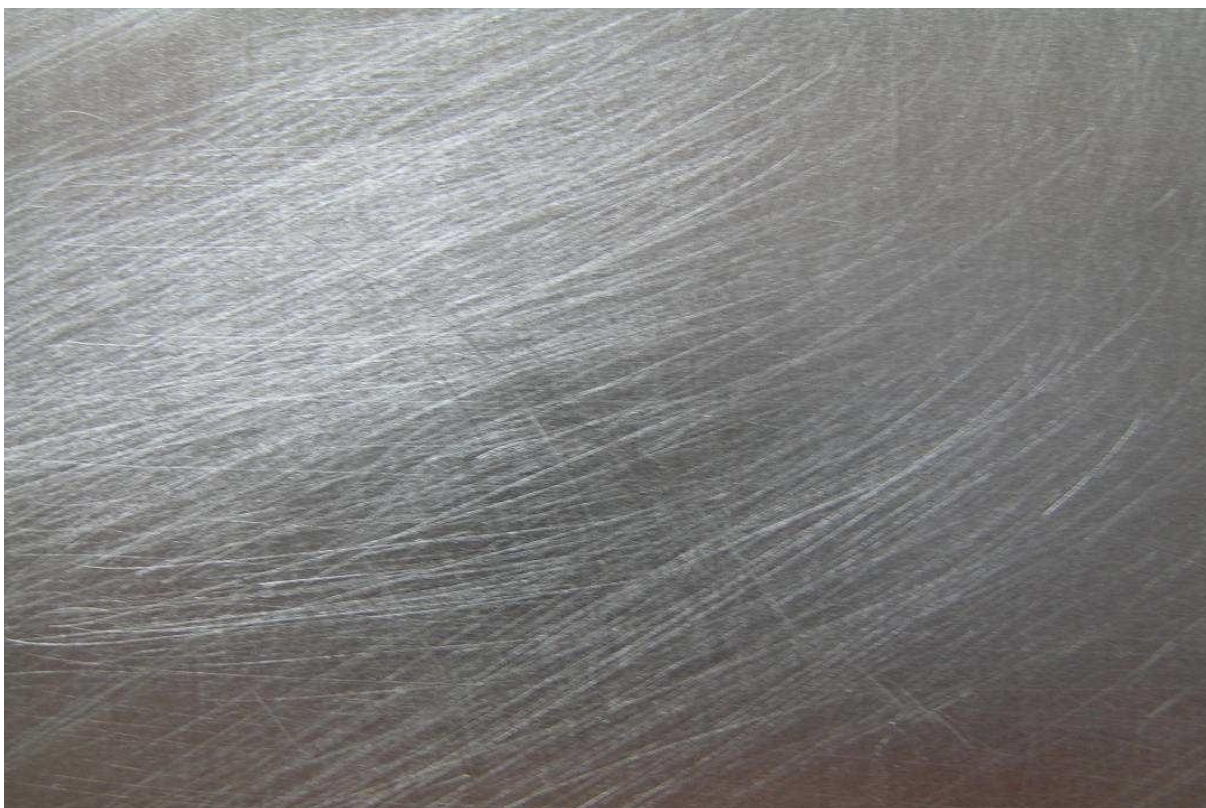
Slika 34 - Mehanički očišćeni čelični lim do stupnja St3 prema HRN EN ISO 8501-1 (brusni papir br. 80)
