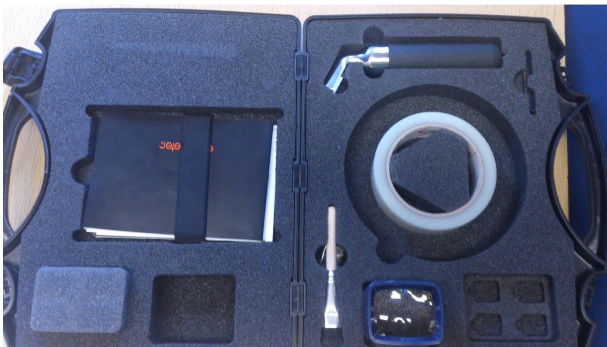
Slika 49 - Elcometar 107 - Zarezivač za provjeravanje prianjanja premaza
