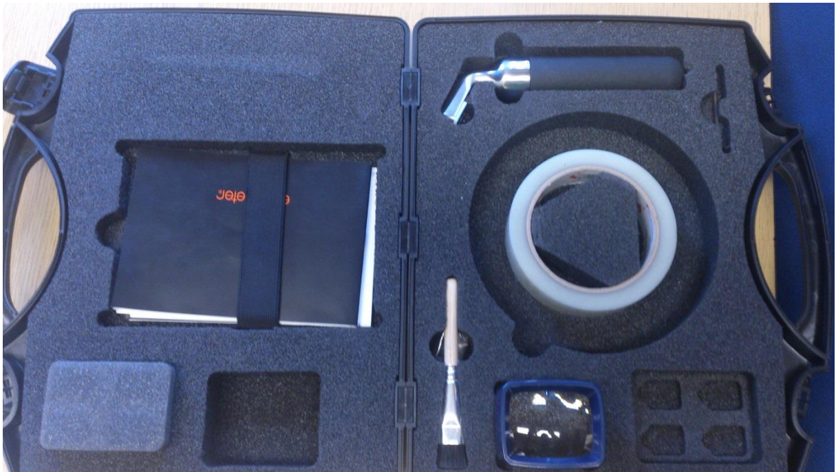
Slika 49 - Elcometar 107 - Zarezivač za provjeravanje prianjanja premaza
