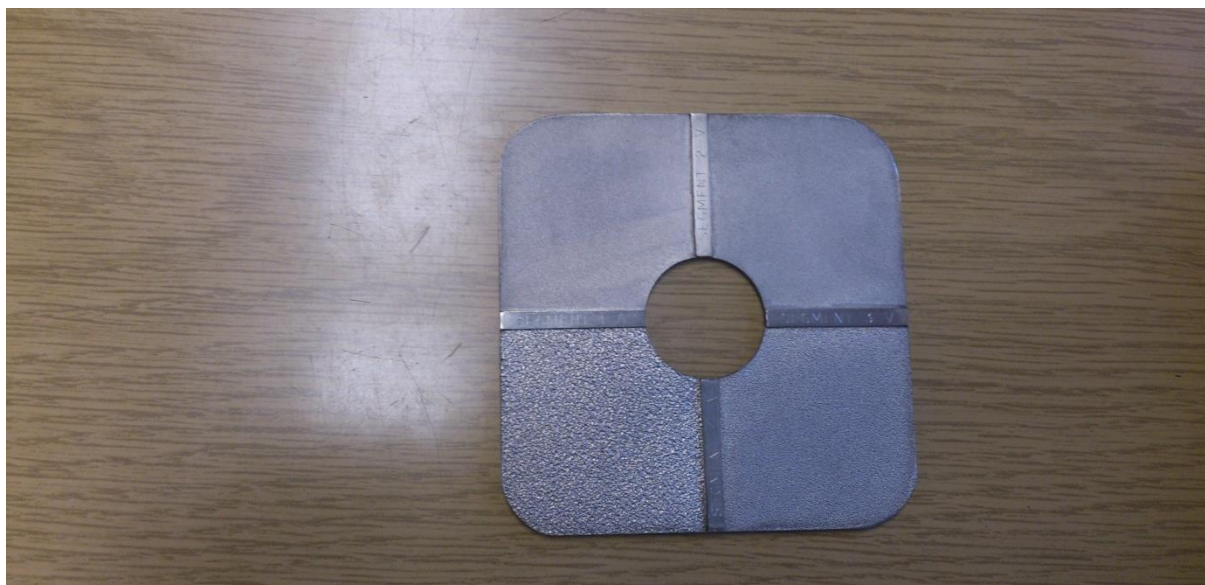
Slika 23 - Komparator za određivanje profila površine
