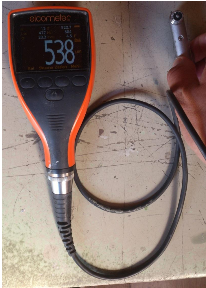
Slika 51 - Elcometer 456 – Digitalni mjerač debljine suhog filma
