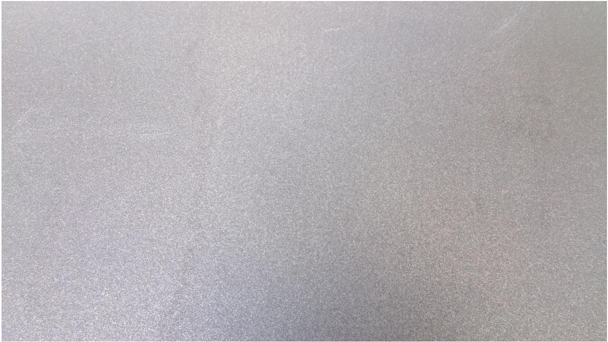
Slika 28 - Pjeskarena površina čelika
