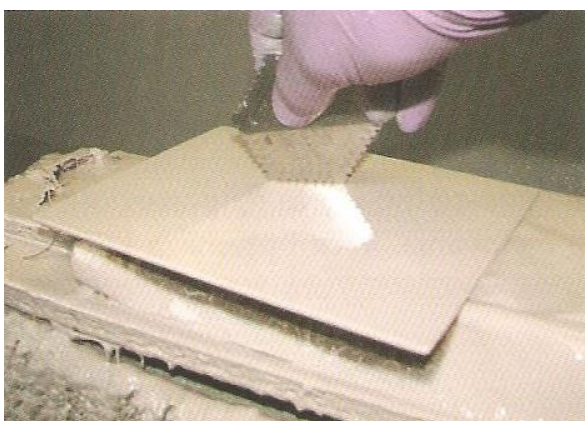
Slika 22 - Mjerenje debljine mokroga filma premaza (DMF) "češljem"
