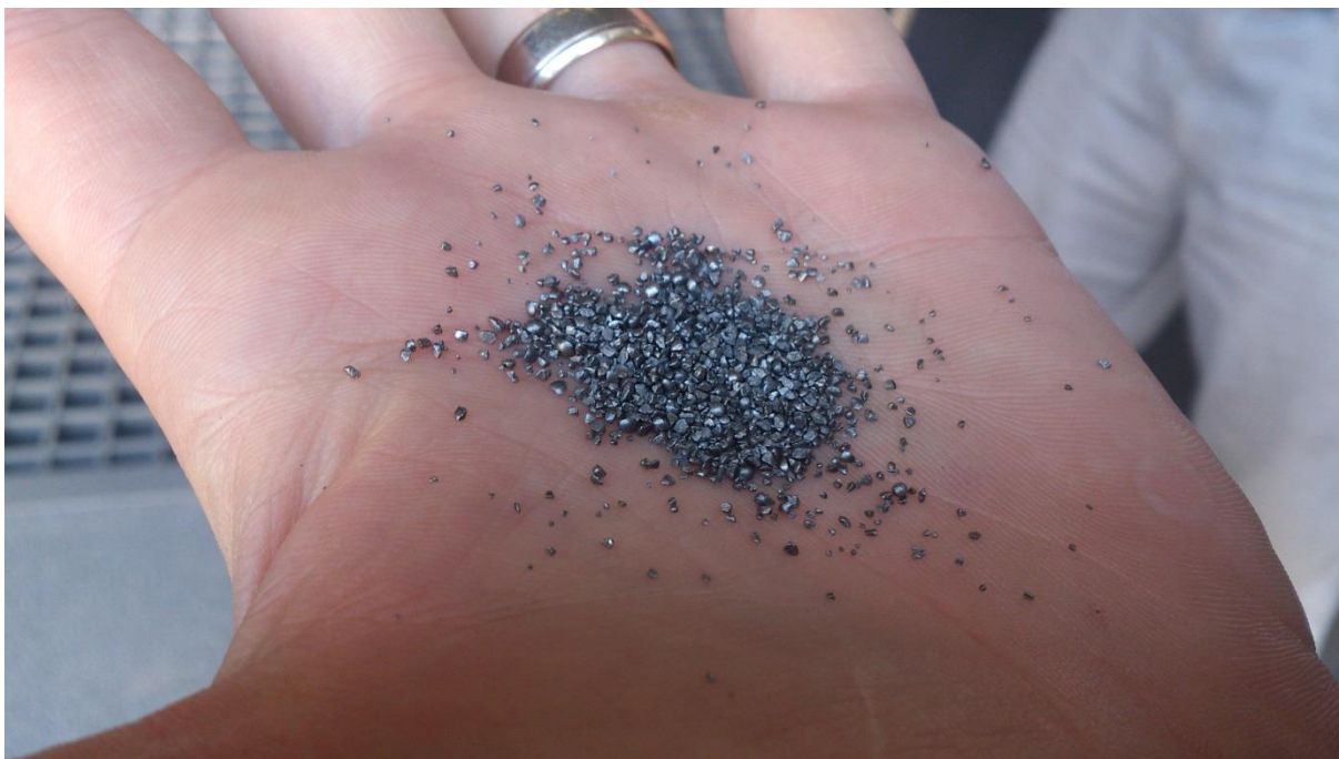
Slika 38 - Zrnca za "pranje" pijeskom (sweep blasting)
