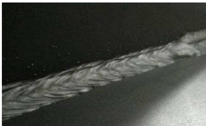
Slika 2.25 Onečišćenje kapljicama metala (602)[5]
