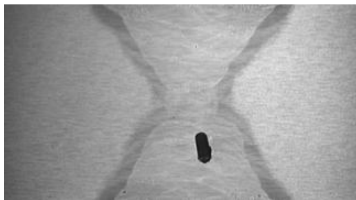
Slika 2.9 Uključak stranog metala (304)[5]
