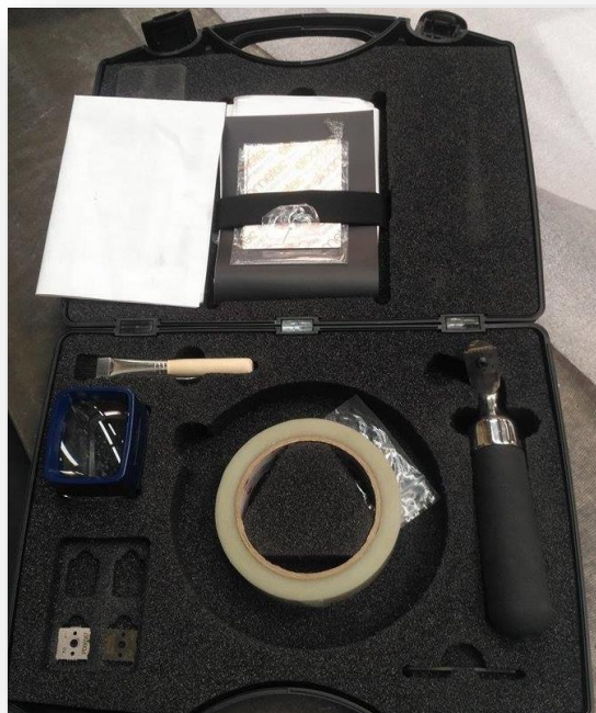
Slika 4.13. Pribor za test prionjivosti
