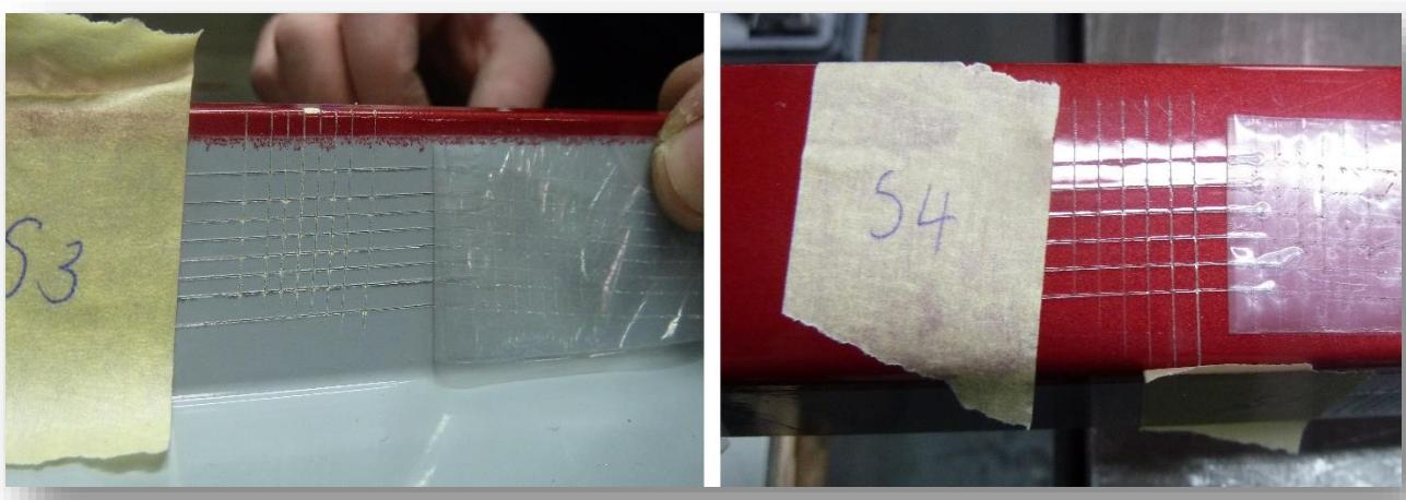
Slika 4.14. Test prionjivosti na poziciji „V“
