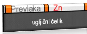
*Slika 3.4. Anodna prevlaka cikla na željezu*
