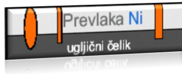
Slika 3.3. Katodna prevlaka nikla na čeliku
