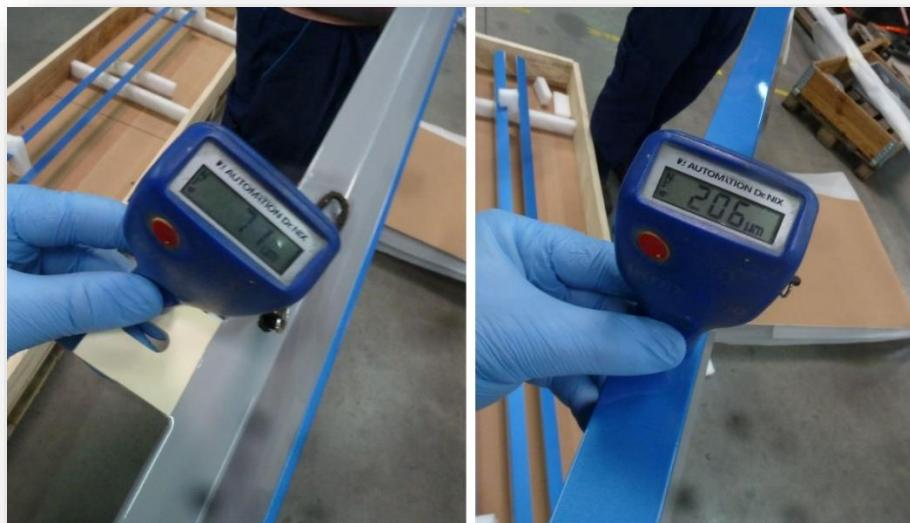
Slika 4.12. Mjerenje debljine nanosa na poziciji „V“
