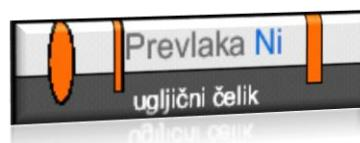
*Slika 3.3. Katodna prevlaka nikla na čeliku*
