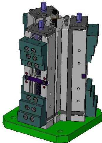
*Slika 2.13 Naprava sa System škripcima*
