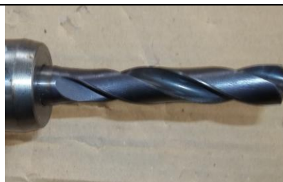
T65 Svrđlo D=13 mm Bušenje rupe za navoj M12 C0-C90
