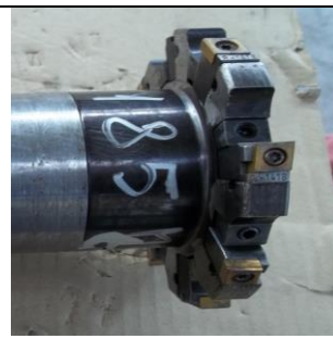
T185 Prstenasto glodalo D125x15 Grubo glodanje vodilica
