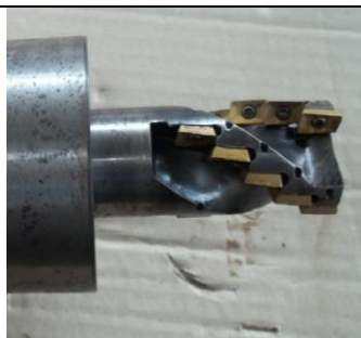
T59 Glodalo D=32, z3 Gruba obrada C0-C270
