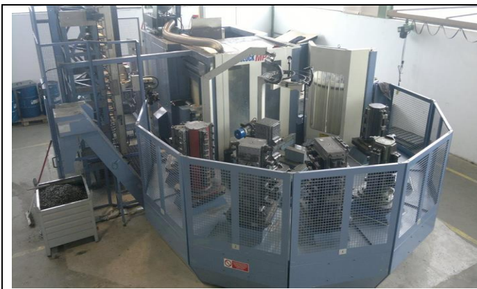
Slika 4.3 Obradni centar MCM-CLOCK T 1200
