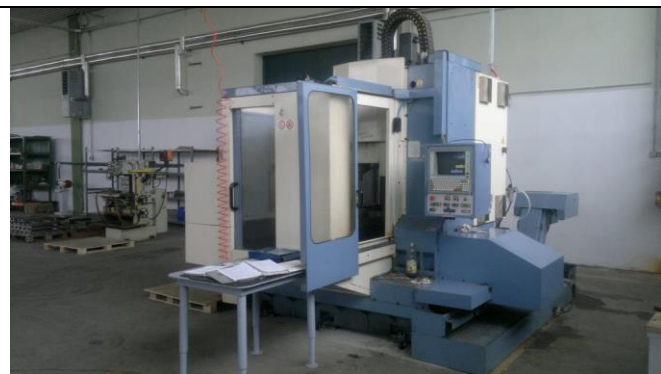
Slika 4.14 Vertikalni obradni centar Famup MCX-1000
