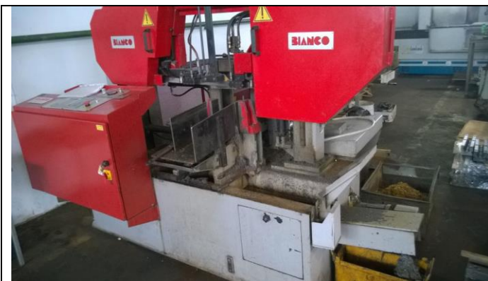
Slika 4.2 Tračna pila Bianco CNC 320
