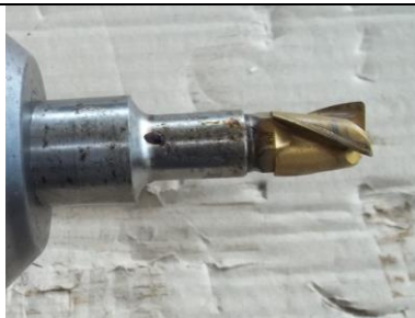
T57 Minimaster glodalo D=16 Fino glodanje bočnog ureza
