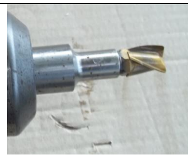
T56 Minimaster glodalo D=16 mm Grubo glodanje bočnog ureza
