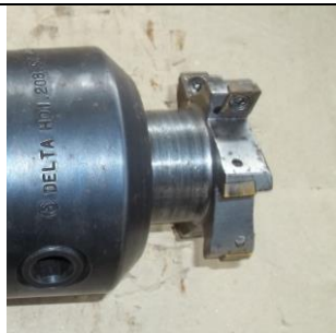
T76 Prsten.glodalo D63x15.27 Glodanje vodilice podnožne pločice
