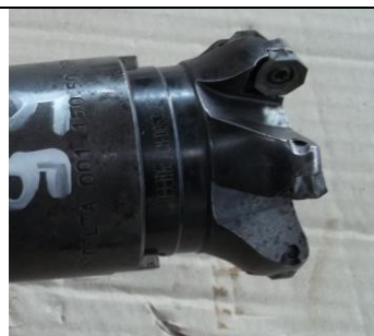
T55 Glodalo D=63, A45 st. Glodanje upuštenja zubi
