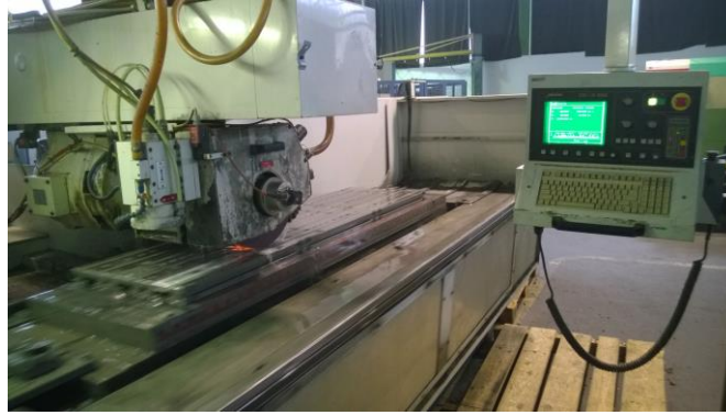
Slika 4.9 Brušenje stražnje strane B
