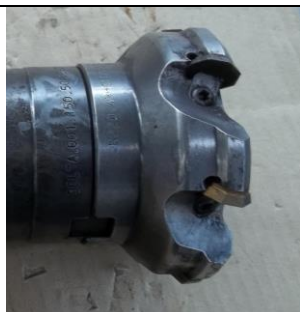
T24 Glodalo D=100 mm, A45 st. Gruba obrada na četiri strane C0-C270
