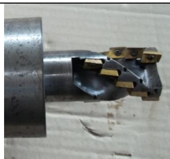
T59 Glodalo D=32, z3 Gruba obrada C0-C270
