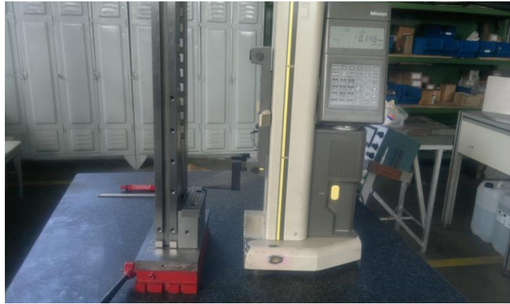
Slika 5.4 Mjerenje udaljenosti dosjeda rupa i čeljusti
