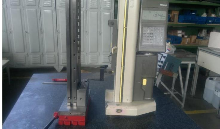
Slika 5.4 Mjerenje udaljenosti dosjeda rupa i čeljusti
