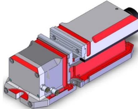
*Slika 2.12 Pneumo hidraulični škripci*
