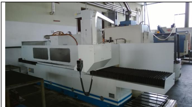
Slika 4.8 Planska brusilica Minini M2000
