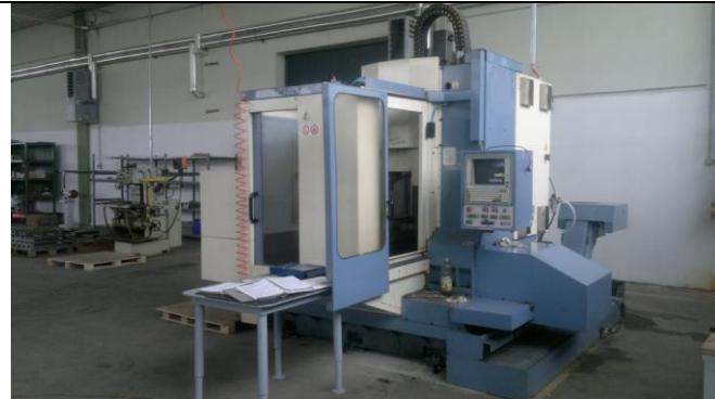
Slika 4.14 Vertikalni obradni centar Famup MCX-1000
