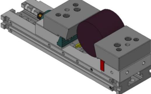
Nadogradnjom sa kosim čeljustima omogućeno je stezanje cilindričnih dijelova.
