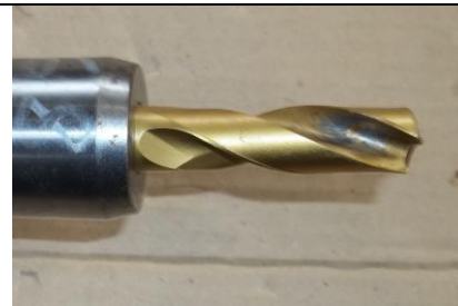
T68 Svrđlo D=15.3 mm Bušenje rupa za klinove C0-C90
