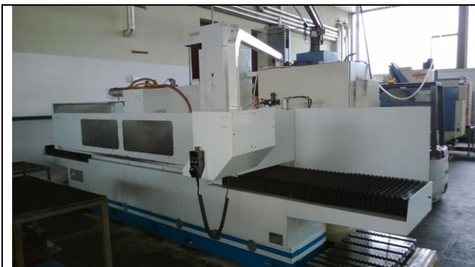
Slika 4.8 Planska brusilica Minini M2000
