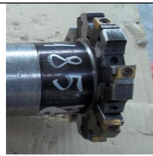
T185 Prstenasto glodalo D125x15 Grubo glodanje vodilica
