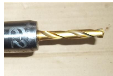
T62 Svrđlo D=8.5 mm Bušenje rupe za navoj M10 C0-C270
