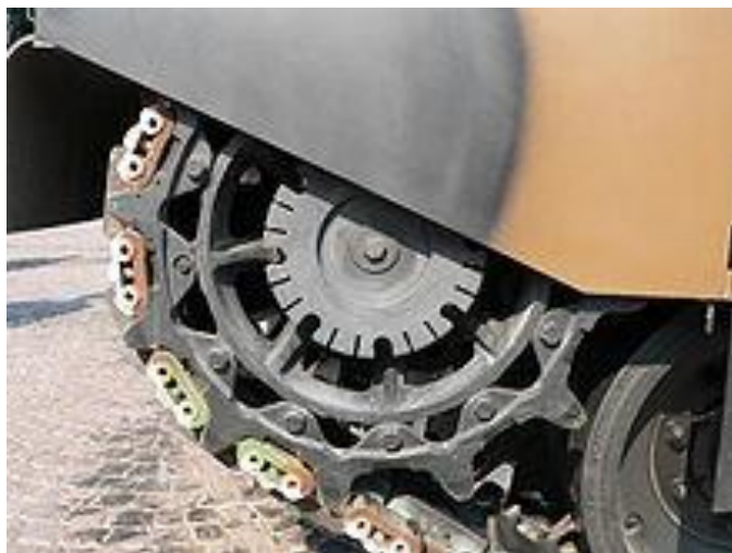
Slika 2.5 Pogonski lančanik od Leclerc glavnog tenka (2006).
