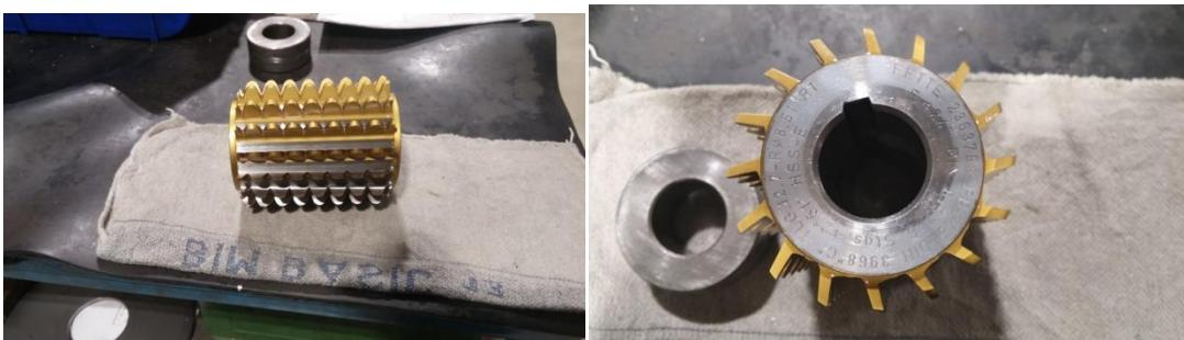
Slika 4.18 Glodalo za izradu zubi na lančaniku
