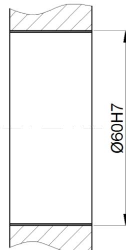
Slika 4.6 Unutarnje fino tokarenje ø60
