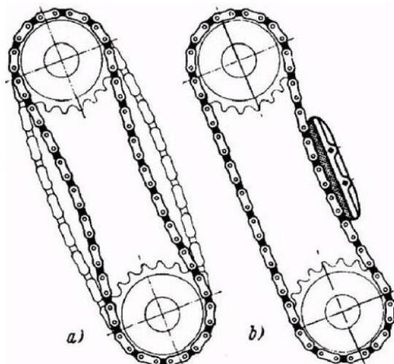
*Slika 2.3 a) amplitude izazvane vibriranjem; b) prijenos s ugrađenim prijenosom*
