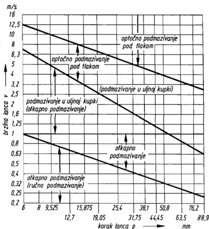
Slika 2.24 Preporučljivi načini podmazivanja za lancaste prijenose prema DIN 8195
