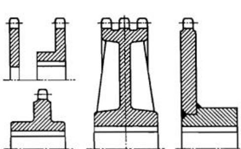
Slika 2.22 Lančanici za valjkaste lance
