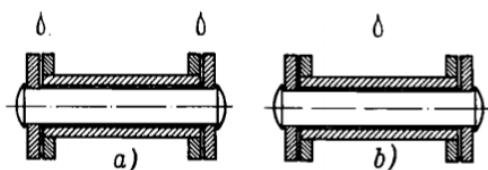
Slika 2.25 Podmazivanje zgloba lanca kapanjem
