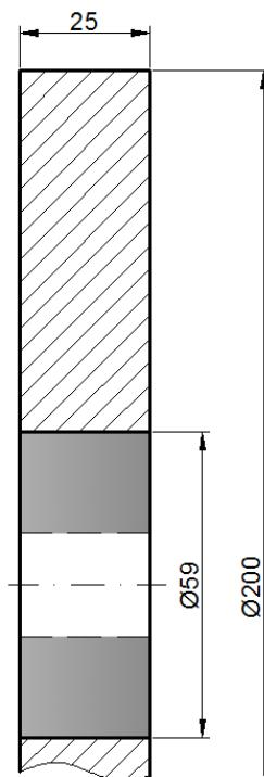
Slika 4.4 Unutarnje tokarenje ø59
