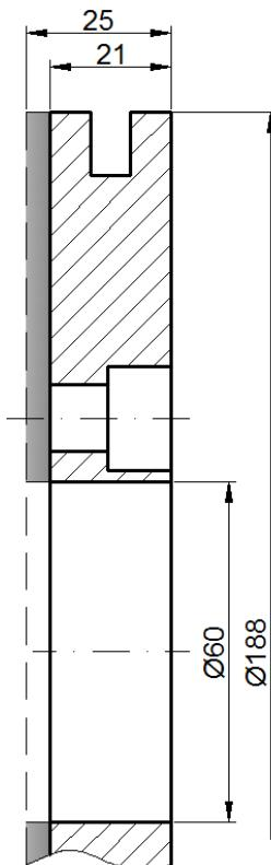
Slika 4.16 Poprečno tokarenje na širinu 21 mm
