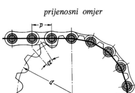
Slika 2.26 Višekutnik (poligon) dobiven obvijanjem lančanika
