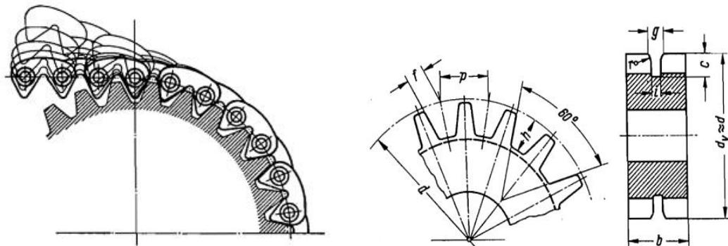
Slika 2.20 Izlazak zupčastog lanca iz uzubina lančanika
