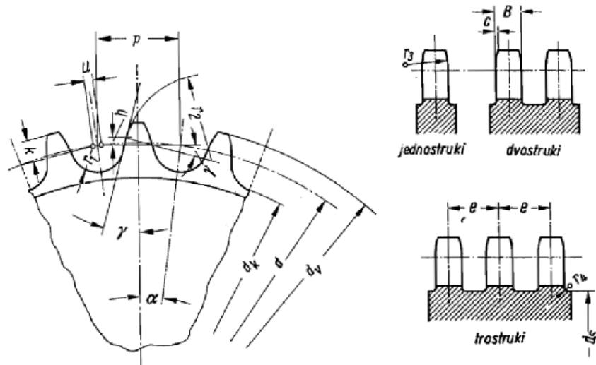
Slika 2.19 Lančanici prema DIN 8196 za valjkaste lance
