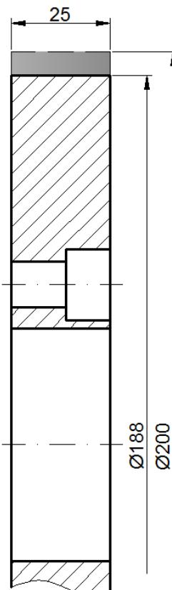
Slika 4.12 Grubo tokarenje ø188
