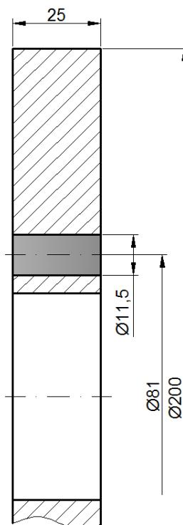
Slika 4.8 Bušenje rupa ø11,5
