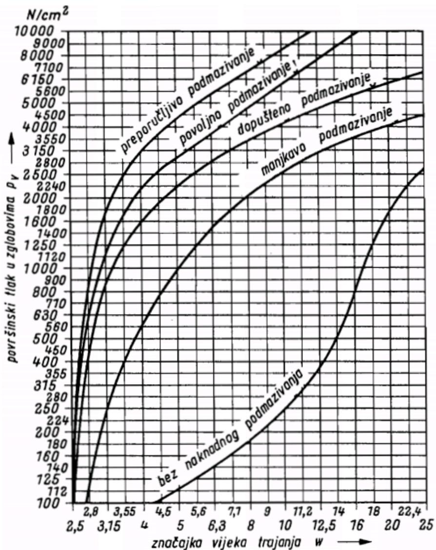
Slika 2.28 Značajka vijeka trajanja  $w$  ovisno o površinskom tlaku u zglobovima  $p_v$  i o načinu podmazivanja prema DIN 8195 za valjkaste lance
