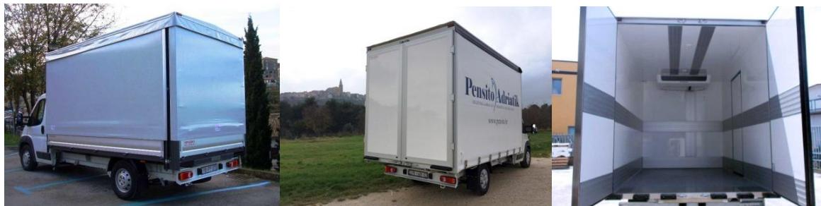
Slika 10. Konstrukcijske izvedbe nadgradnje za smještaj tereta (redoslijed slika:teretni sanduk s bočnim stranicama i ceradom, zatvoreni teretni sanduk sa stražnjim vratima (aluminijski), hladnjača)
