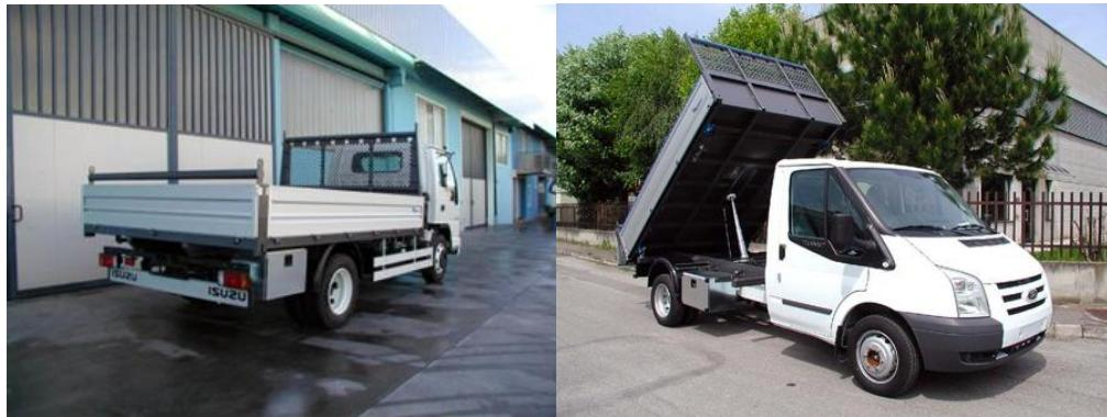
Slika 9. Konstrukcijske izvedbe nadgradnje za smještaj tereta (redoslijed slika: otvoreni teretni sanduk s bočnim stranicama, kiper
