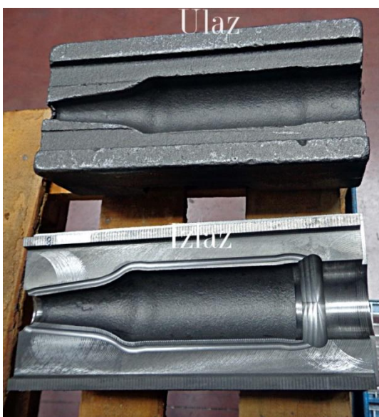
Fotografija 5: Glodanje prije navarivanja - ulaz i izlaz
