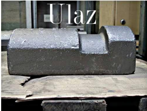
Fotografija 4: Glodanje baza- ulaz i izlaz
