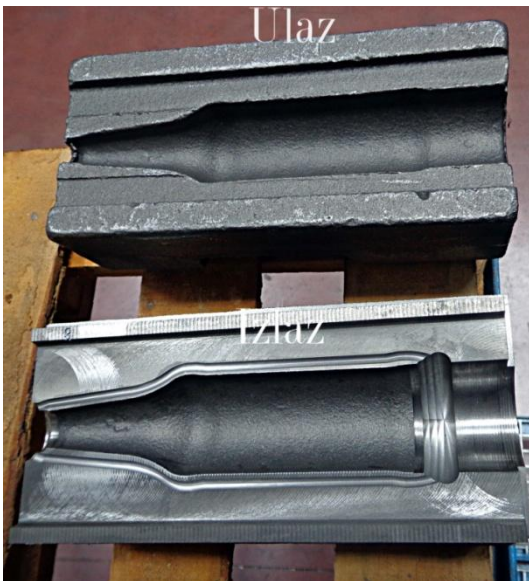
Fotografija 5: Glodanje prije navarivanja - ulaz i izlaz
