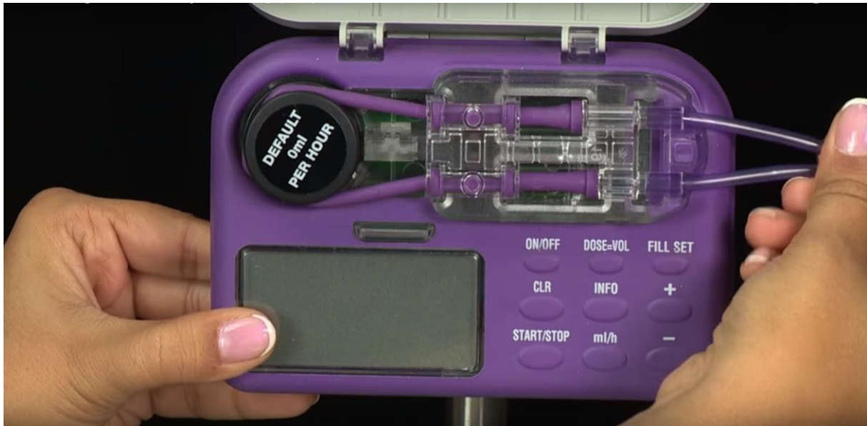
Slika 5.1.2.2. Prikaz umetanja cijevi sistema u pumpu za hranjenje
