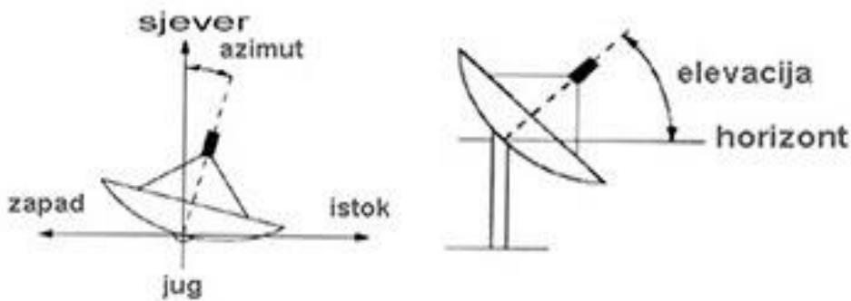
Slika 4.3. Azimut i elevacija
