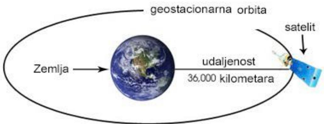
Slika 2.4. Geostacionarna orbita
