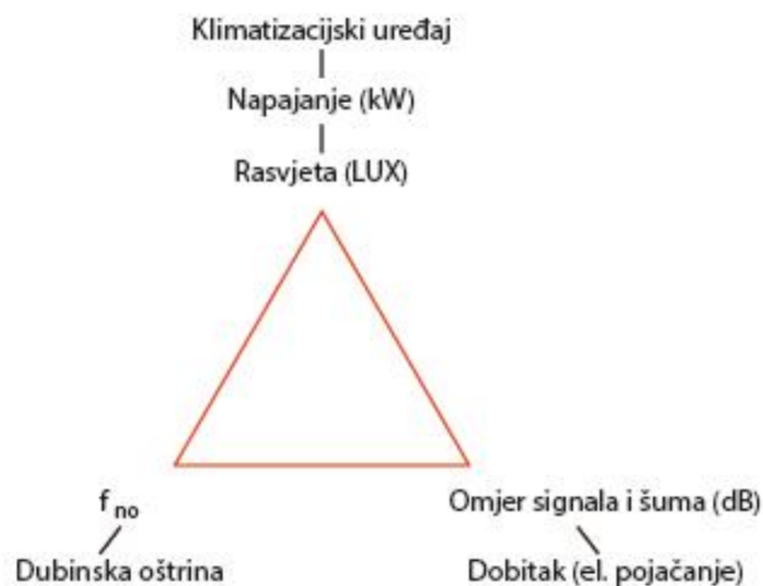
Slika 4.10 Trokut osjetljivosti kamere na svjetlo
