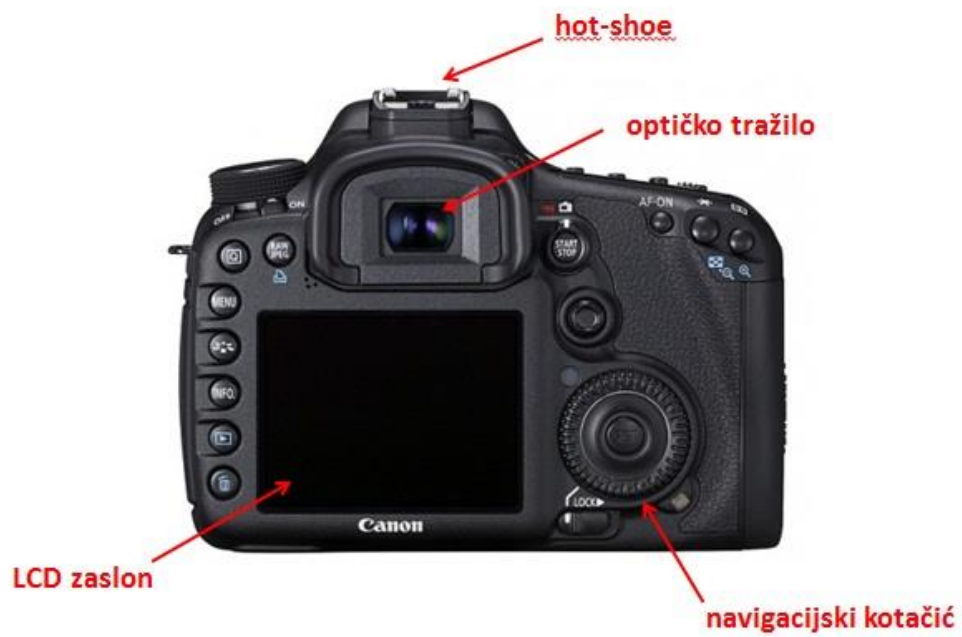
Slika 6.4 - Prikaz LCD zaslona, hot-shoea, optičkog tražila i navigacijskog kotačića
