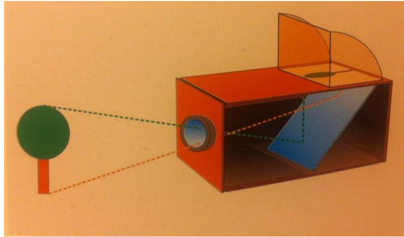
Slika 2.3 Princip rada prijenosne kamere *obscura*
