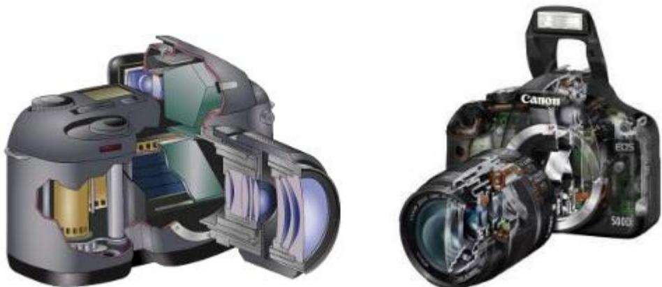
Slika 3.1 Presjek SLR-a i DSLR-a
