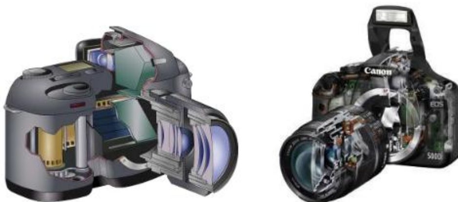
Slika 3.1 Presjek SLR-a i DSLR-a
