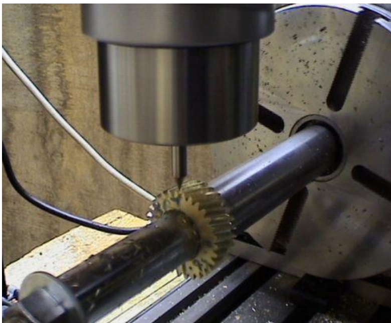
Slika 4.1 Glodanje pomoću profilnog prstastog glodala
