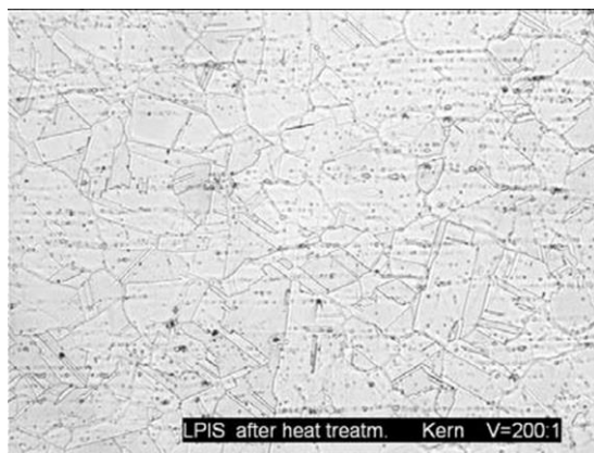
Slika 7.11 Presjek mikrostrukture materijala LPIS na srednjoj zoni nakon toplinske obrade 1170°C / 10 min / voda V = 100:1 60ml HCL / 10 ml HNO 3
